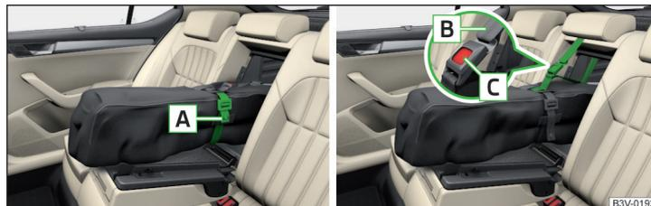
Abb. 121 Band anziehen / Durchladesack sichern
