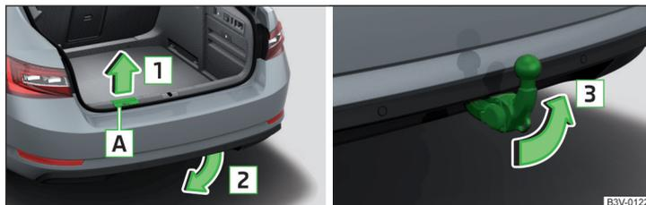
Abb. 304 Kugelstange: heraus-/einschwenken
