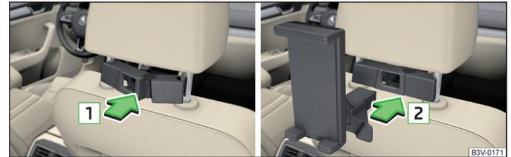
Abb. 128 Einsetzen: Adapter / Halter
