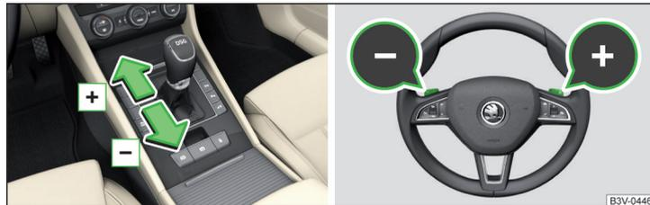
Abb. 259 Wählhebel / Multifunktionslenkrad
