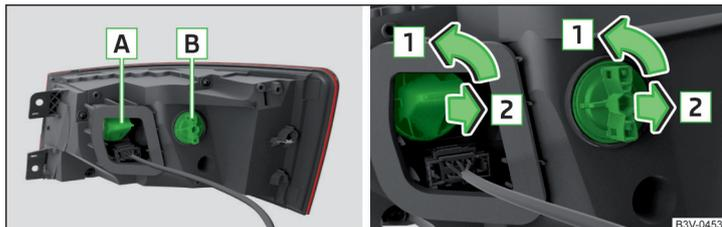
Abb. 361 Rückleuchte / Glühlampe wechseln
