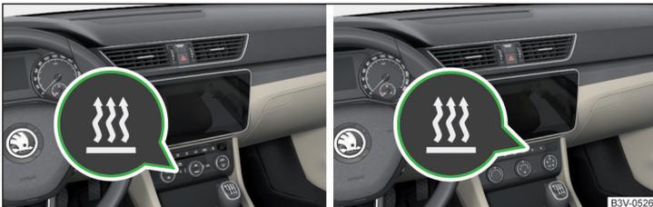
Abb. 167 Taste für das Ein-/Ausschalten (Climatronic / manuelle Klimaanlage)
