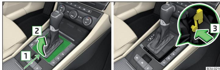
Abb. 345 Abdeckung abnehmen / Wählhebel entriegeln
