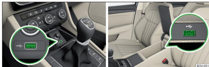
Abb. 103 USB-Eingang vorn / USB-Eingang unter der Armlehne
