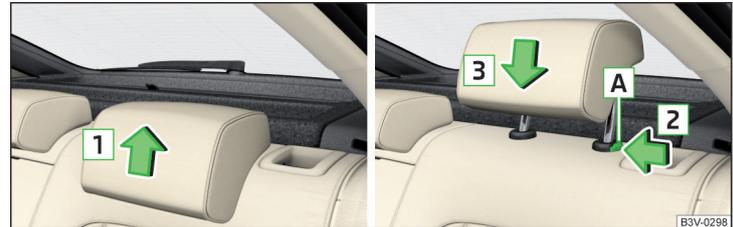
Abb. 91 Höhe der Kopfstütze hinten einstellen
