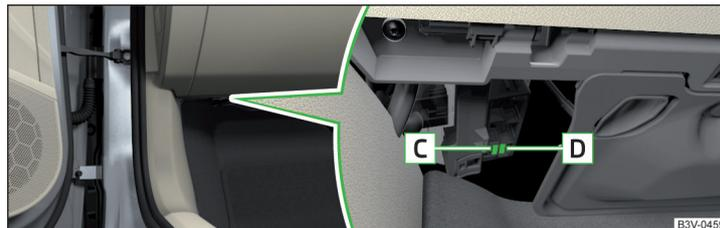
Abb. 353 Sicherungen für die USB-Ladefunktion und für die Multifunktions-einheit (Taxi): Rechtslenker
