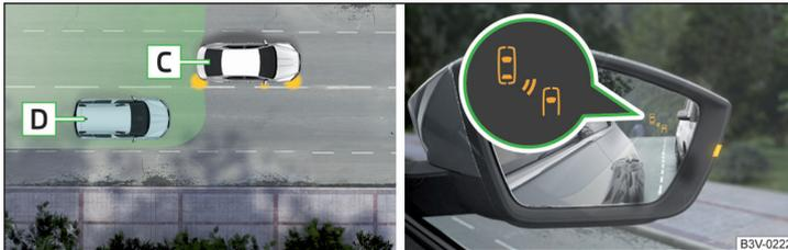
Abb. 272 Fahrsituation / Kontrollleuchte im rechten Außenspiegel weist auf die Fahrsituation hin
