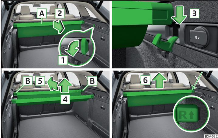
Abb. 148 Multifunktions tasche: herausziehen / einsetzen / einschieben / herausnehmen
