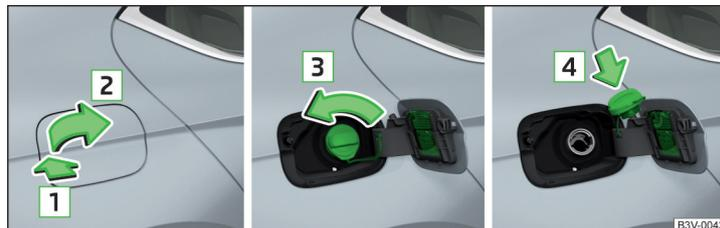
Abb. 308 Tankklappe aufklappen / Tankverschluss herausdrehen / Tankverschluss auf die Tankklappe stecken
