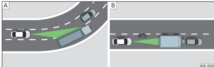
Abb. 293 **Kurvenfahrt / Schmale oder versetzt fahrende Fahrzeuge**
