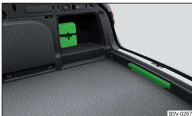
Abb. 321 Platzierung des Verbandskastens und des Warndreiecks: Variante 2
