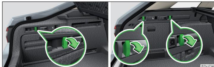
Abb. 136 Haken herunterklappen: Variante 1 / Variante 2
