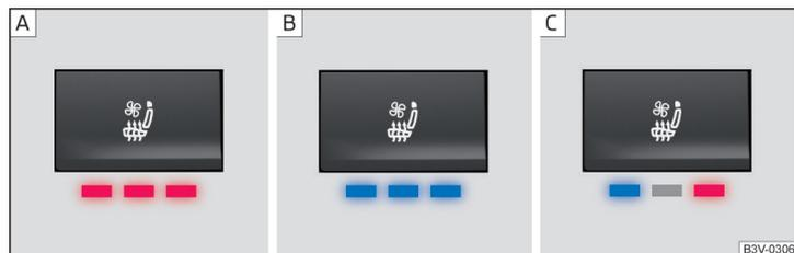
Abb. 95 Heizung eingeschaltet / Belüftung eingeschaltet / Heizung und Belüftung gleichzeitig eingeschaltet
