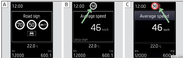
Abb. 302 **Display des Kombi-Instruments: Anzeigebeispiele**
