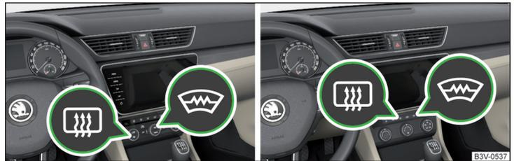
Abb. 71 Tasten für die Front- und Heckscheibenbeheizung: Climatronic / Manuelle Klimaanlage
