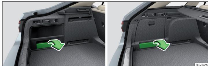
Abb. 144 Cargo-Elemente herausnehmen: Variante 1 / Variante 2
