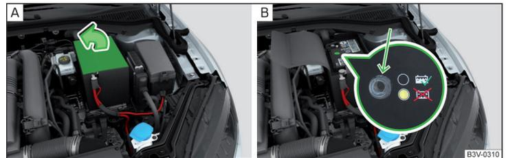
Abb. 317 Fahrzeugbatterie: Abdeckung aufklappen / Säurestandsanzeige
