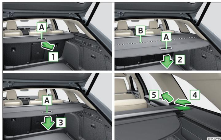
Abb. 141 **Aufrollbare Abdeckung:** herausziehen / aufrollen / Zwischenstellung / herausnehmen
