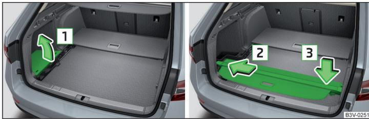
Abb. 142 Seitenabdeckung links abnehmen / Aufrollbare Abdeckung verstauen
