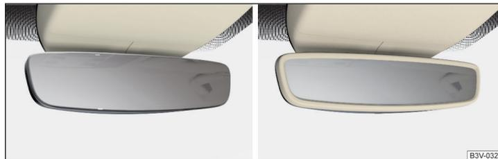
Abb. 78 Innenspiegel mit automatischer Verdunkelung: Variante 1 / Variante 2
