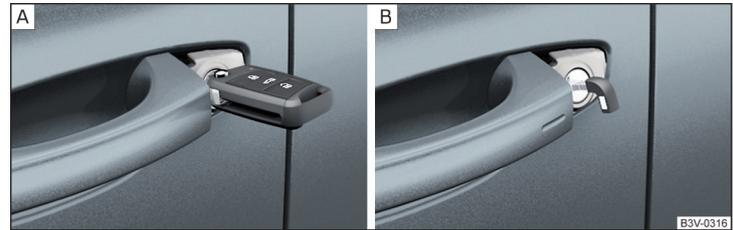
Abb. 342 Griff an der Fahrtür: Schlüssel mit herausklappbarem Schlüsselbart / KESSY-Notschlüssel
