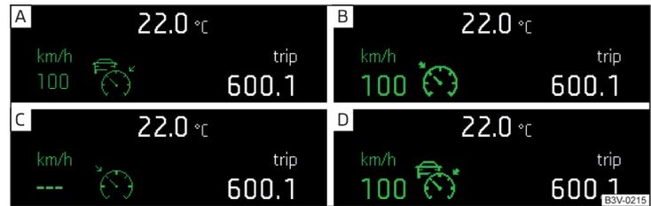
Abb. 291 Display des Kombi-Instruments: Beispiele für Zustandsanzeigen der ACC
