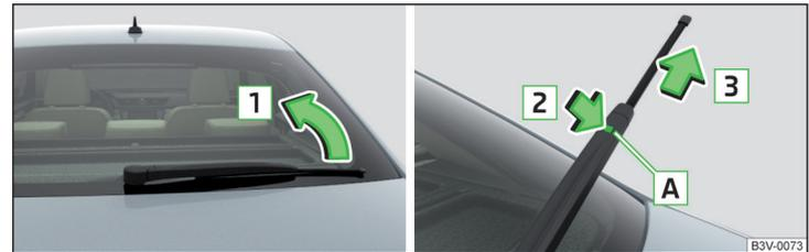
Abb. 348 **Scheibenwischerblatt der Heckscheibe auswechseln**
