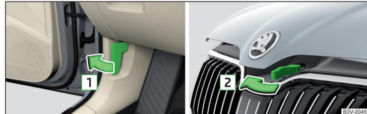
Abb. 311 Motorraumklappe öffnen
