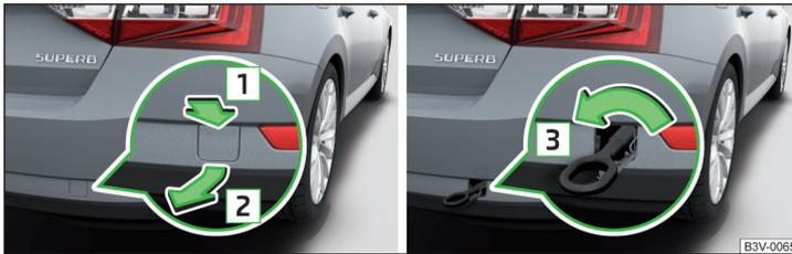
Abb. 335 Abdeckkappe abnehmen / Abschleppöse einbauen
