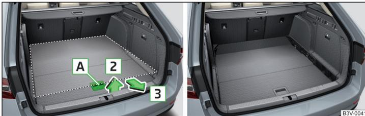
Abb. 153 Variablen Ladeboden in die untere Position einstellen / Variabler Ladeboden in der unteren Position
