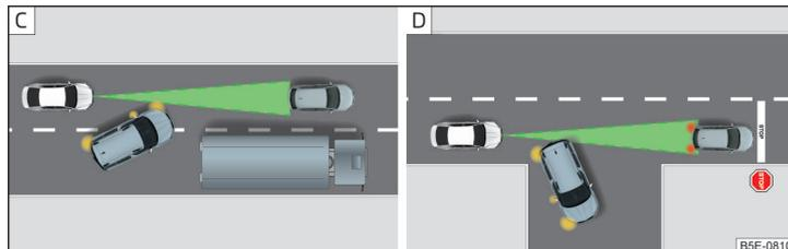
Abb. 294 **Fahrspurwechsel anderer Fahrzeuge / Stehende Fahrzeuge**
