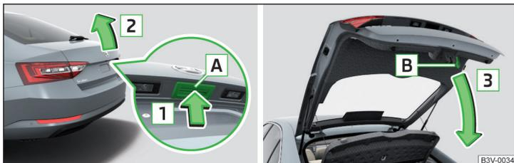
Abb. 51 Gepäckraumklappe öffnen/schließen
