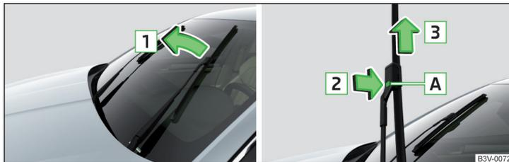
Abb. 347 **Scheibenwischerblatt der Frontscheibe auswechseln**
