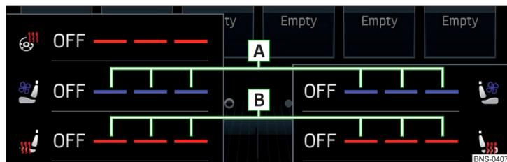
Abb. 96 Infotainmentbildschirm: Vordersitzheizung und -belüftung mit maximaler Heizleistung/Belüftungsstufe eingeschaltet
