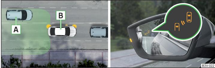
Abb. 271 Fahrsituation / Kontrollleuchte im linken Außenspiegel weist auf die Fahrsituation hin
