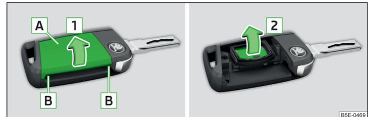
Abb. 336 Abdeckung aufklappen / Batterie herausnehmen
