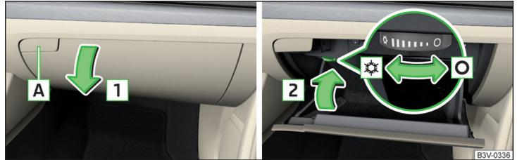
Abb. 112 **Ablagefach öffnen / Ablagefach schließen und Luftzufuhr bedienen**
