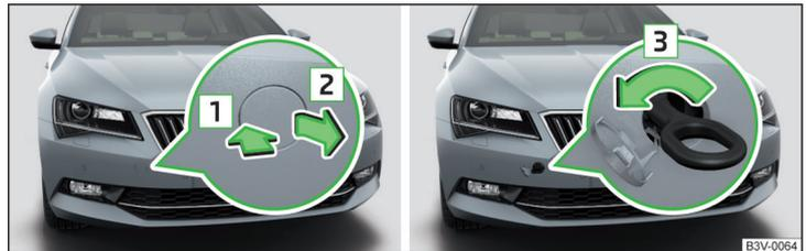
Abb. 334 Abdeckkappe abnehmen / Abschleppöse einbauen
