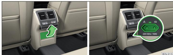
Abb. 125 Abdeckung der 230-Volt-Steckdose aufklappen / 230-Volt-Steckdose
