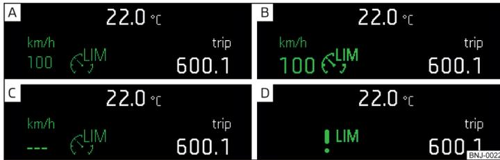
Abb. 287 Display des Kombi-Instruments: Beispiele für Zustandsanzeigen des Geschwindigkeitsbegrenzers
