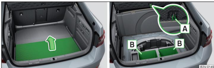
Abb. 146 Variante 1: Bodenbelag anheben / Ablagefächer
