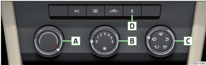
Abb. 160 Bedienelemente der Heizung/Klimaanlage
