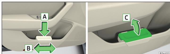
Abb. 107 Abfallbehälter: einsetzen und verschieben / öffnen
