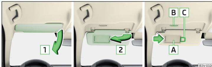
Abb. 72 Blende herunterklappen / Blende hochklappen / Make-up-Spiegel mit Leuchte und Parkzettelhalter
