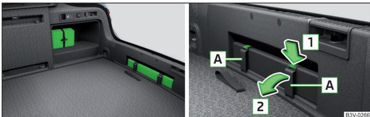
Abb. 320 Platzierung des Verbandskastens und des Warndreiecks: Variante 1 / Warndreieck lösen
