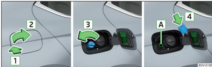
Abb. 310 Tankklappe aufklappen / Tankverschluss herausdrehen / Tankverschluss auf die Tankklappe stecken
