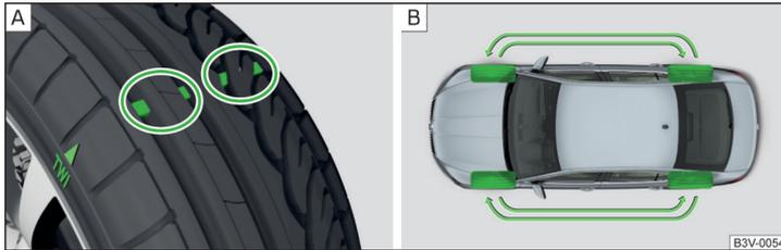
Abb. 319 Reifenverschleißanzeiger / Rädertausch
