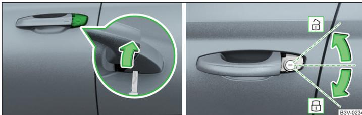
Abb. 341 Griff an der Fahrtür: Schlossabdeckung aufklappen / ent- und verriegeln
