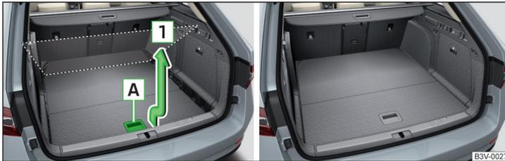
Abb. 152 Variablen Ladeboden in die obere Position einstellen / Variabler Ladeboden in der oberen Position
