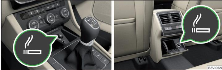
Abb. 127 Zigarettenanzünder: in der Mittelkonsole vorn / in der Mittelkonsole hinten
