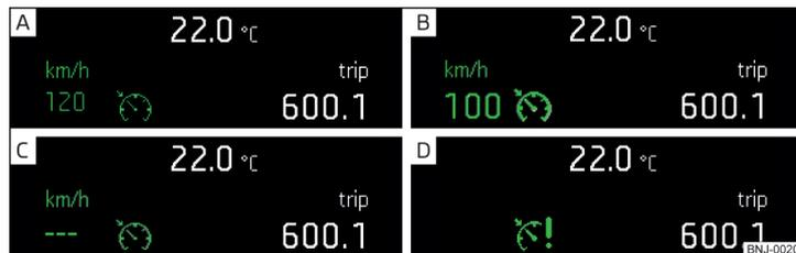
Abb. 285 Display des Kombi-Instruments: Beispiele für Zustandsanzeigen der GRA
