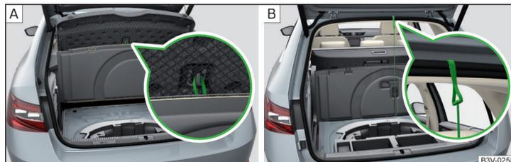
Abb. 137 Bodenbelag befestigen: Variante 1 / Variante 2
