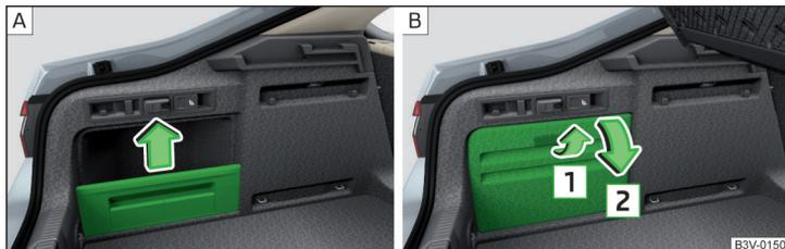
Abb. 143 Seitenablage herausnehmen / Seitenfach öffnen
