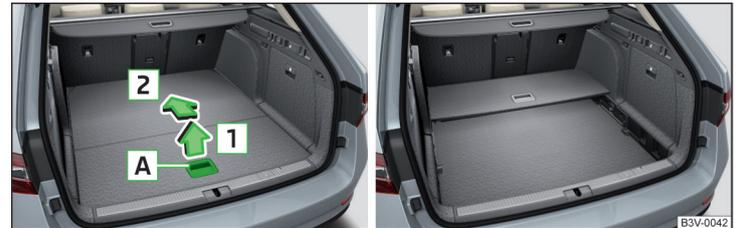
Abb. 154 Variablen Ladeboden zusammenklappen / Zusammengeklappter variabler Ladeboden in der oberen Position
