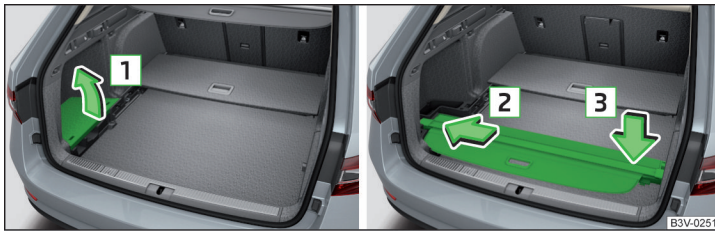
Abb. 129 Seitenabdeckung links abnehmen / Aufrollbare Abdeckung verstauen
