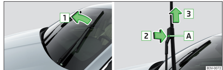
Abb. 354 Scheibenwischerblatt der Frontscheibe austauschen
