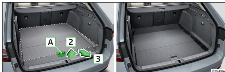
Abb. 140 Variablen Ladeboden in die untere Position einstellen / Variabler Ladeboden in der unteren Position
