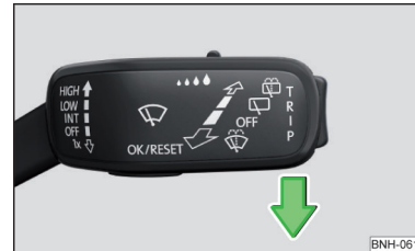
Abb. 353 Servicestellung der Scheibenwischerarme einstellen
