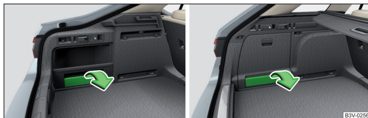
Abb. 131 Cargo-Elemente herausnehmen: Variante 1 / Variante 2
