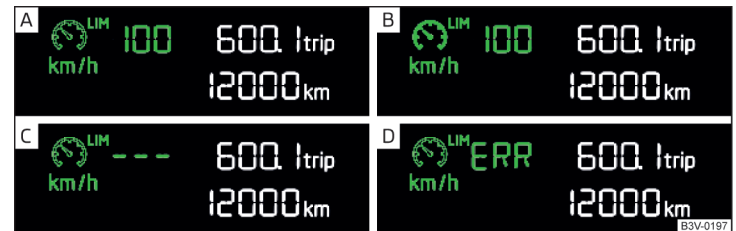
Abb. 291 Segmentdisplay: Beispiele für Zustandsanzeigen des Geschwindigkeitsbegrenzers
