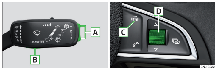
Abb. 301 Tasten/Einstellrad: am Bedienungshebel / am Multifunktionslenkrad
