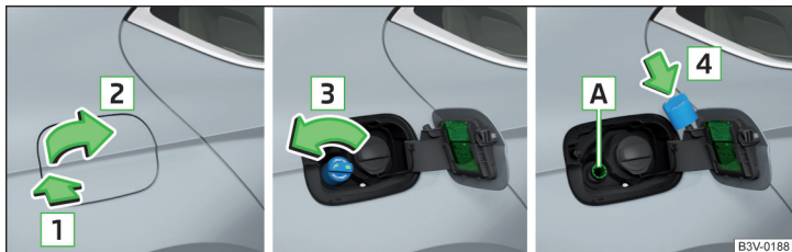
Abb. 317 Tankklappe aufklappen / Tankverschluss herausdrehen / Tankverschluss auf die Tankklappe stecken
