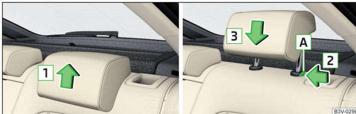
Abb. 78 Höhe der Kopfstütze hinten einstellen
