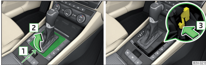
Abb. 352 Abdeckung abnehmen / Wählhebel entriegeln
