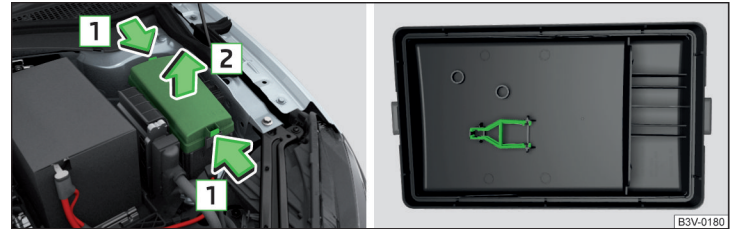
Abb. 361 Abdeckung des Sicherungskastens: Abdeckung abnehmen / Kunststoffklammer für Sicherungen
