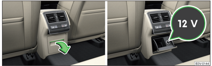
Abb. 110 Ablagefach öffnen / Abdeckung der 12-Volt-Steckdose
