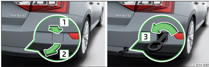
Abb. 342 Abdeckkappe abnehmen / Abschleppöse einbauen
