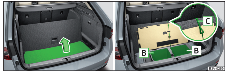
Abb. 134 Variante 2: Bodenbelag anheben / Ablagefächer
