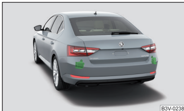
Abb. 271 Verbauort der Radarsensoren
