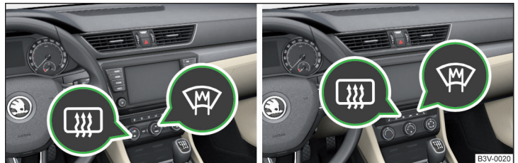
Abb. 59 Tasten für die Front- und Heckscheibenbeheizung: Climatronic / Manuelle Klimaanlage
