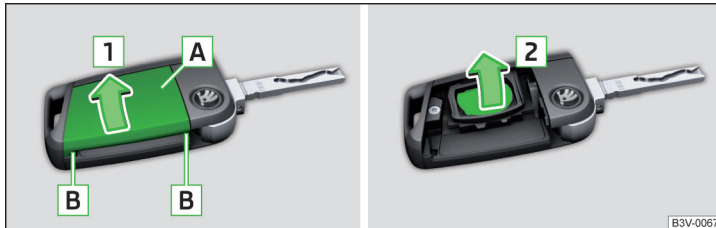
Abb. 343 Abdeckung abnehmen / Batterie herausnehmen
