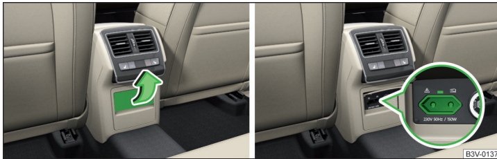
Abb. 112 Abdeckung der 230-Volt-Steckdose aufklappen / 230-Volt-Steckdose
