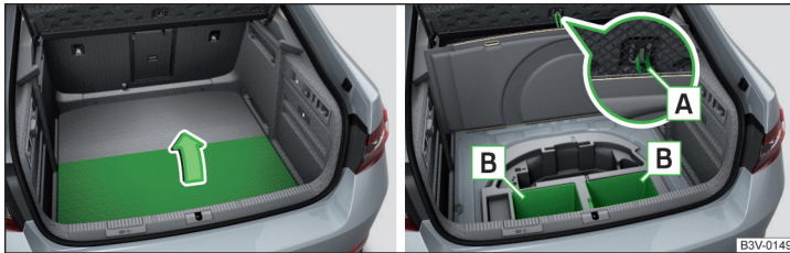
Abb. 133 Variante 1: Bodenbelag anheben / Ablagefächer
