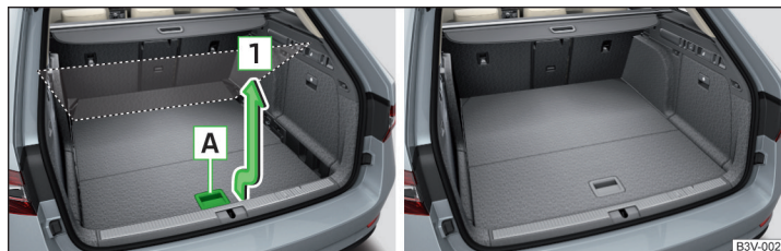
Abb. 139 Variablen Ladeboden in die obere Position einstellen / Variabler Ladeboden in der oberen Position
