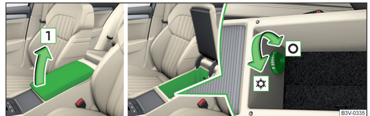
Abb. 95 Ablagefach öffnen / Luftzufuhr bedienen
