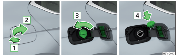
Abb. 315 Tankklappe aufklappen / Tankverschluss herausdrehen / Tankverschluss auf die Tankklappe stecken
