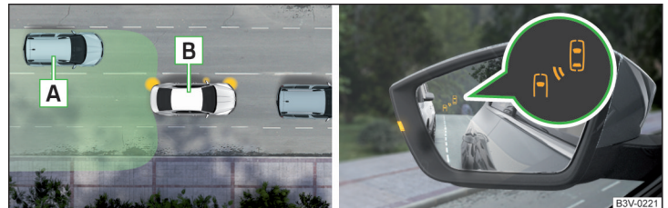
Abb. 273 Fahrsituation / Kontrollleuchte im linken Außenspiegel weist auf die Fahrsituation hin
