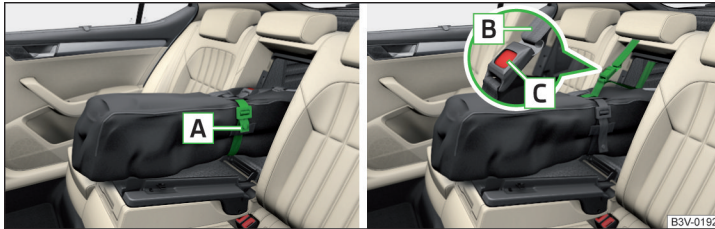
Abb. 107 Band anziehen / Durchladesack sichern
