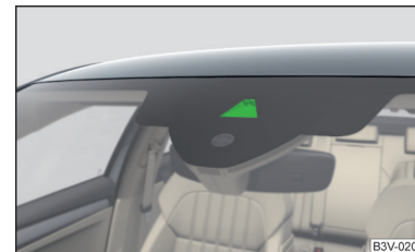
Abb. 53 Sensorsichtfenster für den Scheinwerferassistenten
