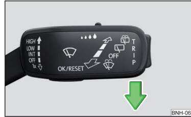
Abb. 251 Servicestellung der Scheibenwischerarme einstellen
