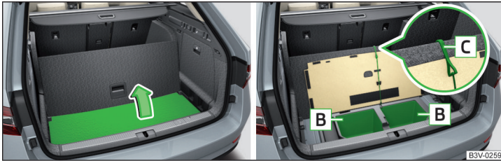
Abb. 132 Variante 2: Bodenbelag anheben / Ablagefächer
