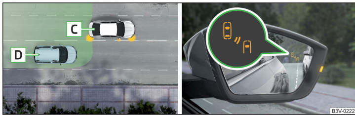
Abb. 173 Fahr situation / Kontrollleuchte im rechten Außenspiegel weist auf die Fahr situation hin
