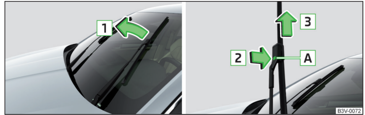
Abb. 252 Scheibenwischerblatt der Frontscheibe austauschen
