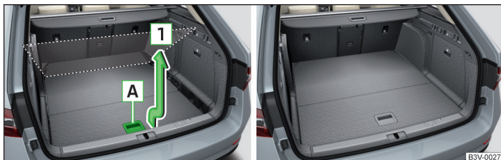
Abb. 135 Variablen Ladeboden in die obere Position einstellen / Variabler Ladeboden in der oberen Position
