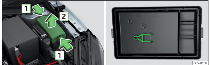
Abb. 259 Abdeckung des Sicherungskastens: Abdeckung abnehmen / Kunststoffklammer für Sicherungen
