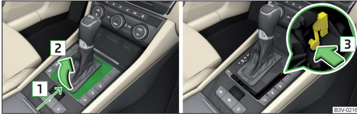
Abb. 250 Abdeckung abnehmen / Wählhebel entriegeln
