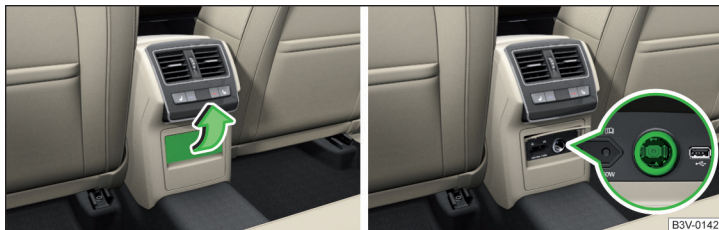
Abb. 105 Abdeckung aufklappen / 12-Volt-Steckdose
