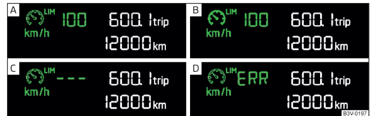
Abb. 190 Segmentdisplay: Beispiele für Zustandsanzeigen des Geschwindigkeitsbegrenzers
