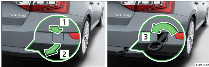
Abb. 240 Abdeckkappe abnehmen / Abschleppöse einbauen
