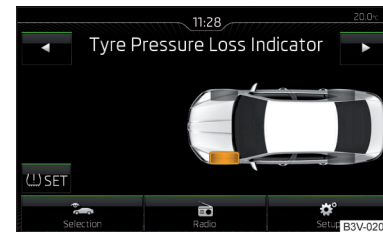
Abb. 206 Taste für Speicherung der Druckwerte / Beispiel der Displayanzeige: das System weist auf eine Reifendruckänderung vorn links hin
