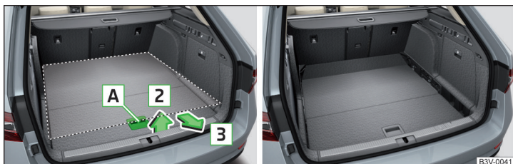
Abb. 136 Variablen Ladeboden in die untere Position einstellen / Variabler Ladeboden in der unteren Position
