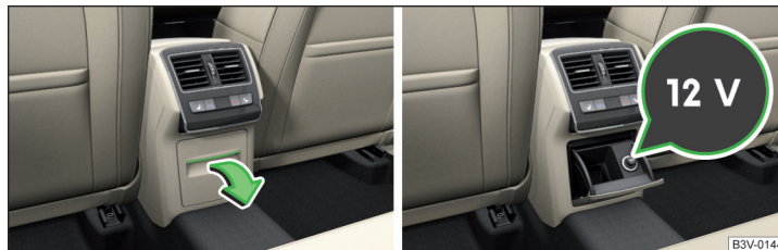
Abb. 106 Ablagefach öffnen / Abdeckung der 12-Volt-Steckdose
