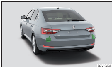
Abb. 170 Verbauort der Radarsensoren
