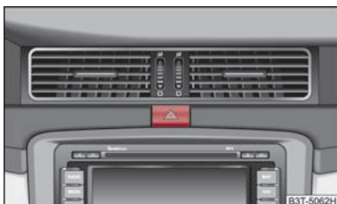
Abb. 52 Schalttafel: Schalter für Warnblinkanlage
