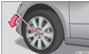
Abb. 201 Radwechsel: Radschrauben lockern
