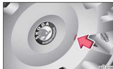
Abb. 200 Abziehen der Radzierkappe bei Leichtmetallrädern
