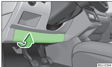
Abb. 157 Unterseite der Schalttafel: Abdeckung des Sicherungskastens
