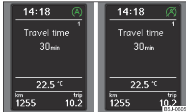
Abb. 120 MAXI DOT-Display: Motor ist automatisch abgeschaltet / automatische Motorabschaltung ist nicht möglich
