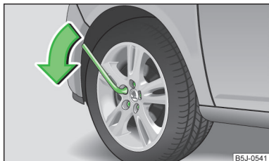
Abb. 144 Radwechsel: Radschrauben lösen
