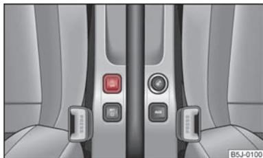
**Abb. 83** Mittelkonsole: Taste **START-STOPP-System**
