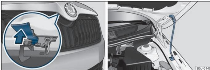
Abb. 122 Kühlergrill: Sicherungshebel / Sicherung der Motorraumklappe mit der Klappenstütze
