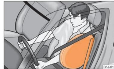
Abb. 101 Gasgefüllter Seiten-Airbag
