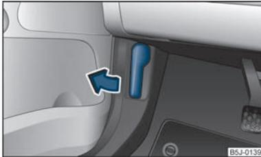
Abb. 121 Entriegelungshebel Motorraumklappe
