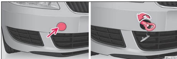
Abb. 144 Vorderer Stoßfänger: Abdeckung / Einbau der Abschleppöse
