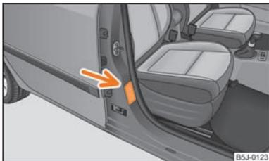
Abb. 105 Aufkleber an der mittleren Karoseriesäule auf der Beifahrerseite
