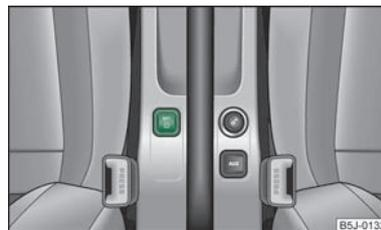
Abb. 114 Taste zum Einstellen des Reifendruck-Kontrollwertes
