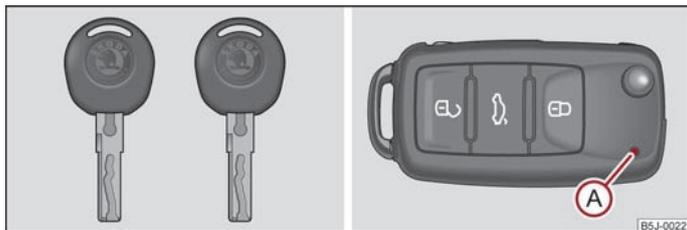
Abb. 9 Schlüsselsatz ohne Fernbedienung / Schlüssel mit Funkschlüssel
