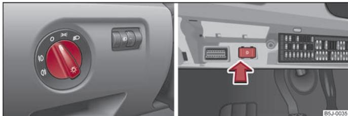
Abb. 21 Schalttafel: Lichtschalter / Schalter für Tagfahrlicht
