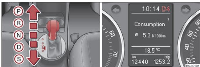
Abb. 84 Wählhebel / Informationsdisplay: Wählhebelstellungen
