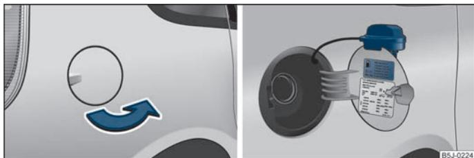
Abb. 120 Fahrzeugseite hinten rechts: Tankklappe / Tankklappe mit abgeschraubtem Verschluss
