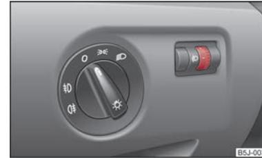
**Abb. 23** Schalttafel: Leuchtweitenregulierung
