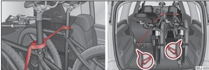
Abb. 56 Absicherung der Fahrräder mit Schellen / Absicherung der Fahrräder mit einem Band
