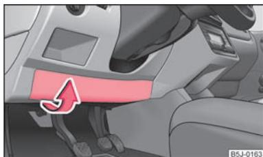
Abb. 146 Untere Seite der Schalttafel: Sicherungsdeckel
