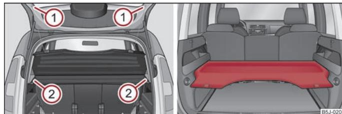
Abb. 47 Ausbau der Gepäckraumabdeckung / Gepäckraumabdeckung in der unteren Position
