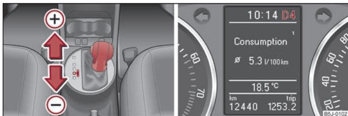
Abb. 85 Wählhebel: manuelles Schalten / Großes Informationsdisplay: manuelles Schalten
