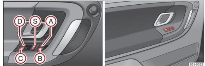
Abb. 19 Tasten in der Fahrertür / Tasten in den hinteren Türen
