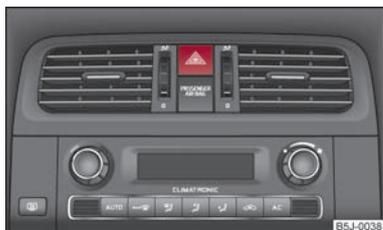
Abb. 24 Schalttafel: Schalter für Warnblinkanlage
