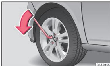
Abb. 137 : Radschrauben lösen
