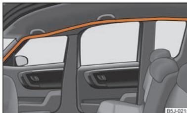
Abb. 102 Einbauort des Kopf-Airbags
