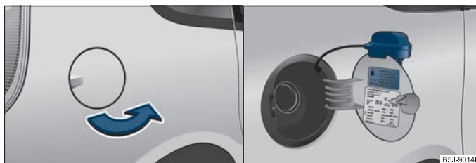
Abb. 133 Fahrzeugseite hinten rechts: Tankklappe / Tankklappe mit abgeschraubtem Verschluss
