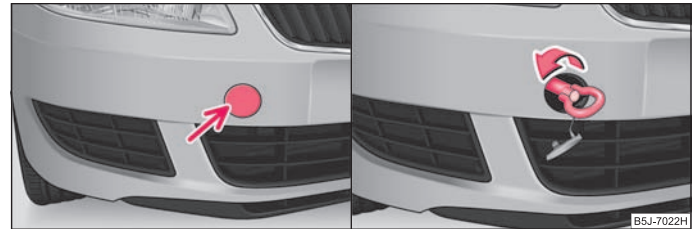
Abb. 156 Vordere Stoßfänger: Abdeckung / Einbau der Abschleppöse
