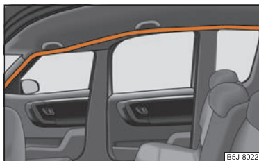
Abb. 115 Einbauort des Kopf-Airbags
