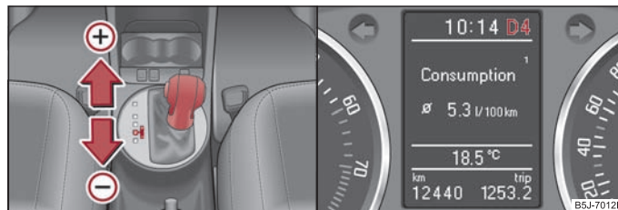
Abb. 98 Wählhebel: manuelles Schalten / Großes Informationsdisplay: manuelles Schalten
