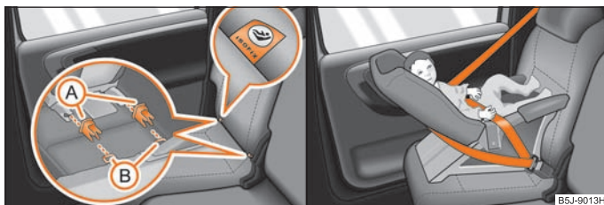
Abb. 124 Halteösen (ISOFIX-System) / Schieben des ISOFIX-Kindersitzes in die montierten Aufnahmebühnen
