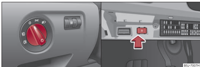
Abb. 34 Schalttafel: Lichtschalter / Schalter für Tagfahrlicht
