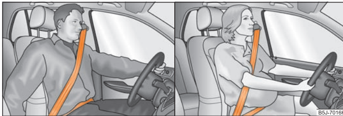
Abb. 107 Gurtbandverlauf des Schulter- und Beckengurtes / Gurtbandverlauf bei schwangeren Frauen
