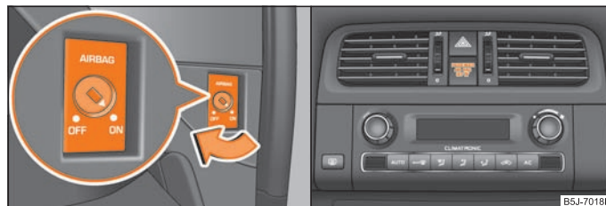
Abb. 117 Schalter für Front-Beifahrer-Airbag / Kontrollleuchte für Beifahrer-Airbagabschaltung
