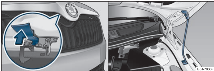
Abb. 135 Kühlergrill: Sicherungshebel / Sicherung der Motorraumklappe mit der Klappenstütze
