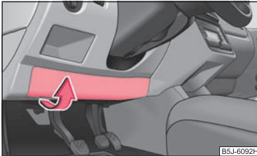
Abb. 158 Untere Seite der Schalttafel: Sicherungsdeckel
