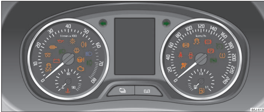
Abb. 21 Kombi-Instrument mit Kontrollleuchten
