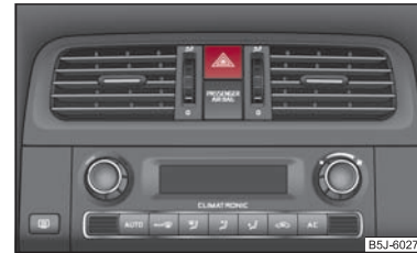
Abb. 37 Schalttafel: Schalter für Warnblinkanlage
