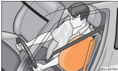
Abb. 114 Seiten-Airbag ausgelöst
