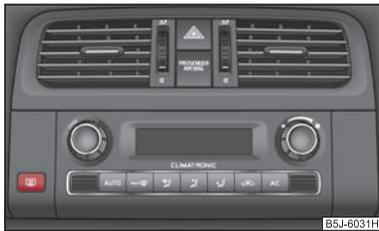
Abb. 41 Schalter für Heckscheibenbeheizung
