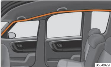
Abb. 115 Einbauort des Kopf-Airbags
