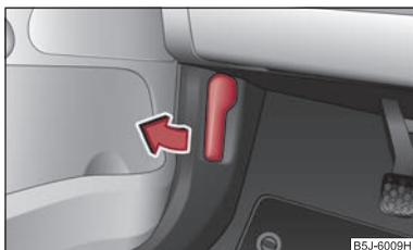
Abb. 12 Entriegelungshebel für Motorraumklappe
