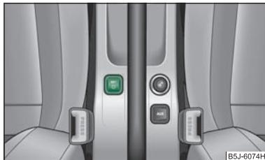
Abb. 127 Taste zum Einstellen des Reifendruck-Kontrollwertes
