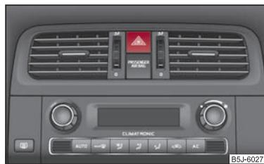
**Abb. 37** Schalttafel: Schalter für Warnblinkanlage
