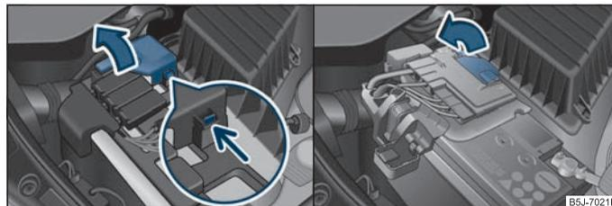
Abb. 140 Batterie: Abdeckung hochklappen (automatisches Getriebe) / (Schaltgetriebe)
