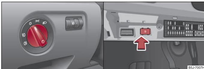
Abb. 34 Schalttafel: Lichtschalter / Schalter für Tagfahrlicht
