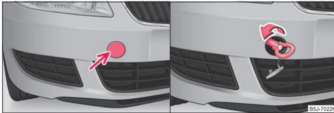
Abb. 154 Vorderer Stoßfänger: Schutzgitter / Einbau der Abschleppöse
