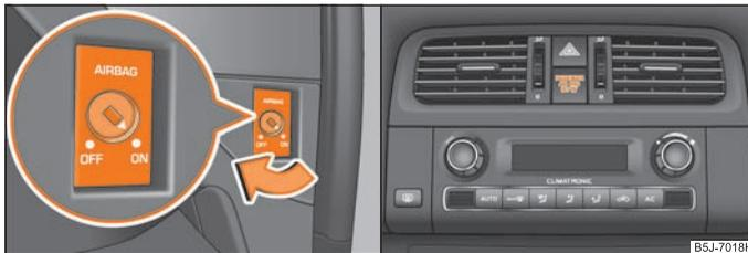
Abb. 117 Schalter für Front-Beifahrer-Airbag / Kontrollleuchte für Beifahrer-Airbagabschaltung
