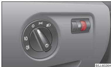
**Abb. 36** Schalttafel: Leuchtweitenregulierung
