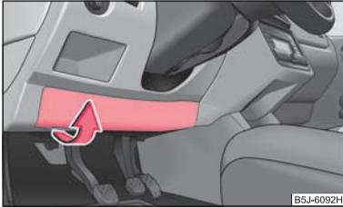
Abb. 156 Untere Seite der Schalttafel: Sicherungsdeckel
