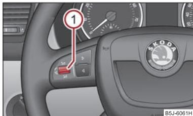
Abb. 103 Multifunktionslenkrad: Telefonbedienung
