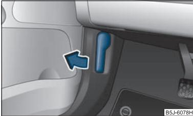
Abb. 134 Entriegelungshebel für Motorraumklappe
