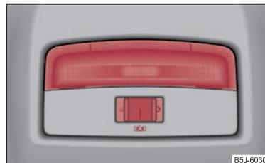
Abb. 40 Dachhimmelleuchte
