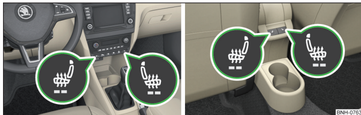
Abb. 73 Tasten für die Beheizung der Vordersitze / Rücksitze
