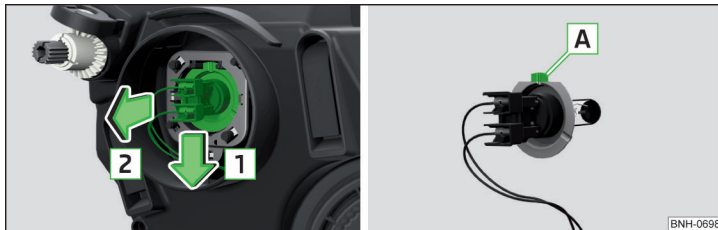
Abb. 265 Glühlampe für Abblendlicht wechseln
