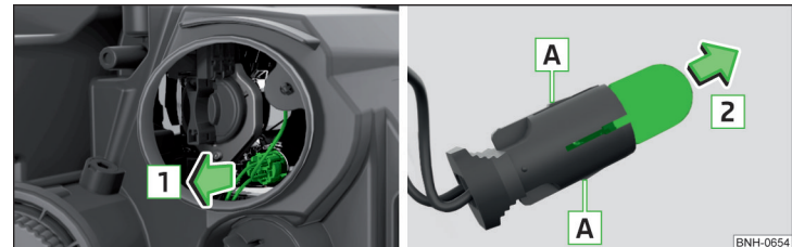
Abb. 264 Glühlampe für Standlicht wechseln
