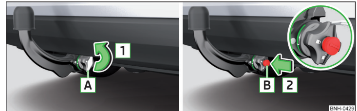
Abb. 217 Kappe vom Schloss abnehmen / Schlüssel in das Schloss stecken
