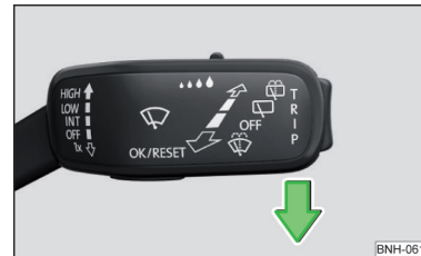
Abb. 253 Servicestellung der Scheibenwischerarme einstellen
