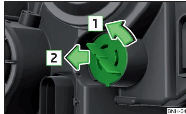
Abb. 266 Glühlampe für Blinklicht vorn wechseln
