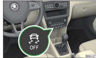
Abb. 191 Taste des ASR-Systems
