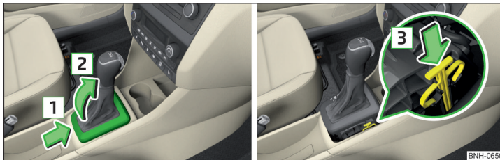
Abb. 252 Abdeckung abnehmen / Wählhebel entriegeln
