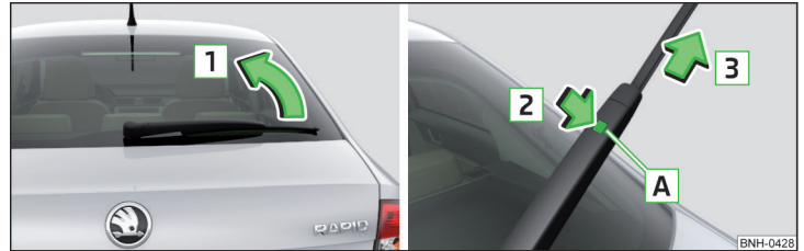
Abb. 255 Scheibenwischerblatt der Heckscheibe auswechseln
