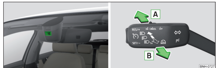
Abb. 55 Verbaort des Sensors / System ein-/ausschalten
