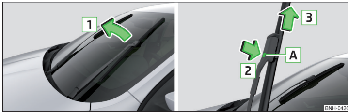
Abb. 254 Scheibenwischerblatt der Frontscheibe auswechseln
