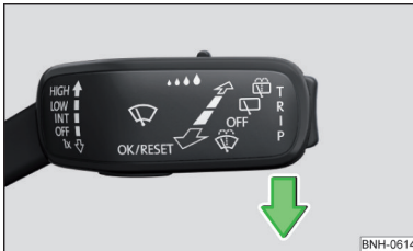
Abb. 260 Servicestellung der Scheibenwischerarme einstellen
