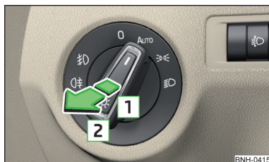
Abb. 61 Lichtschalter - Nebelscheinwerfer/Nebelschlussleuchte einschalten
