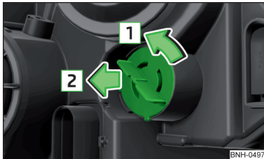
Abb. 273 Glühlampe für Blinklicht vorn wechseln
