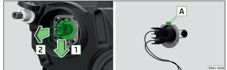
Abb. 272 Glühlampe für Ablendlicht wechseln
