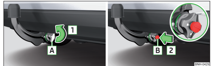
Abb. 221 Kappe vom Schloss abnehmen / Schlüssel in das Schloss stecken
