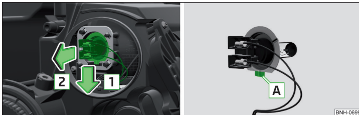
Abb. 274 Glühlampe für Fernlicht wechseln
