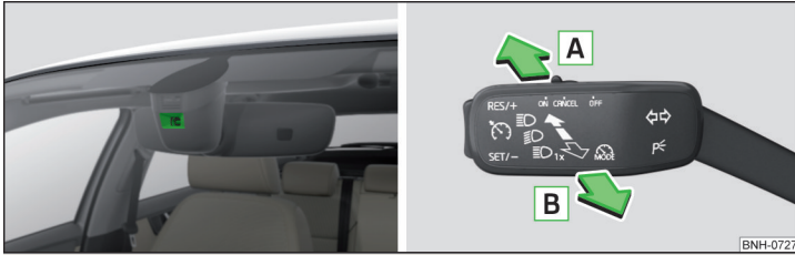
Abb. 60 Sensorsichtfenster für den Fernlichtassistenten / System ein-/ausschalten
