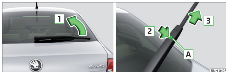
Abb. 262 Scheibenwischerblatt der Heckscheibe auswechseln
