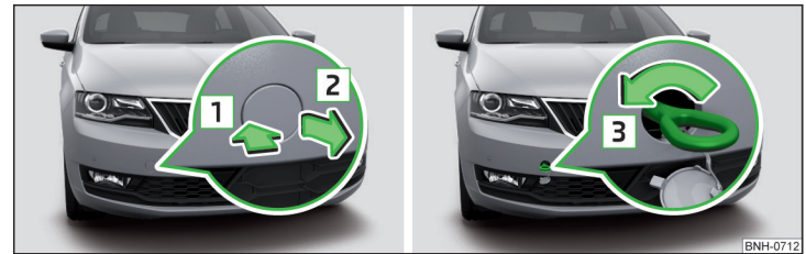
Abb. 253 Abdeckkappe abnehmen / Abschleppöse einbauen
