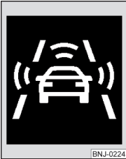
Abb. 210 Display des Kombi-Instruments: Vorwarnung bzw. Notbremsung bei niedriger Geschwindigkeit
