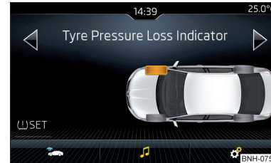
Abb. 212 Taste für Speicherung der Druckwerte / Beispiel der Bildschirmanzeige: das System weist auf eine Reifendruckänderung vorn rechts hin
