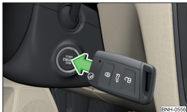
Abb. 184 Motor anlassen - Knopf mit dem Schlüssel drücken
