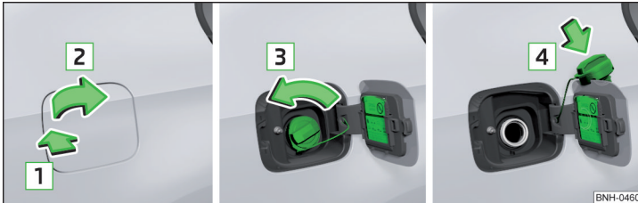
Abb. 144 Tankklappe aufklappen / Tankverschluss herausdrehen / Tankverschluss auf die Tankklappe stecken
