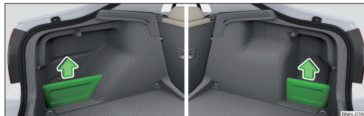
Abb. 92 Ablagefachabdeckung links/rechts abnehmen
