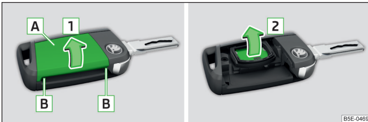
Abb. 170 Abdeckung abnehmen / Batterie herausnehmen
