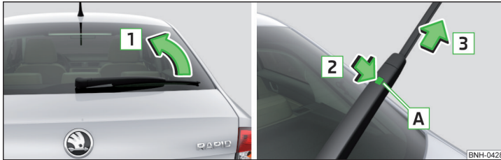
Abb. 177 Scheibenwischerblatt der Heckscheibe auswechseln
