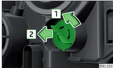
Abb. 188 Glühlampe für Blinklicht vorn wechseln
