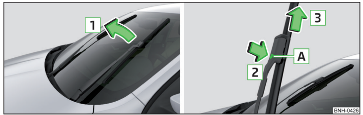
Abb. 176 Scheibenwischerblatt der Frontscheibe austauschen
