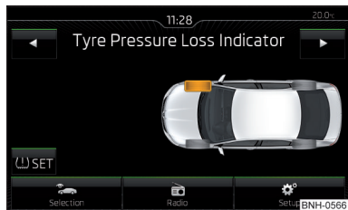
Abb. 127 Taste für Speicherung der Druckwerte / Beispiel der Displayanzeige: das System weist auf eine Reifendruckänderung vorn rechts hin
