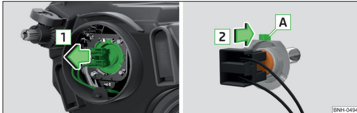
Abb. 185 Glühlampe für Abblendlicht wechseln
