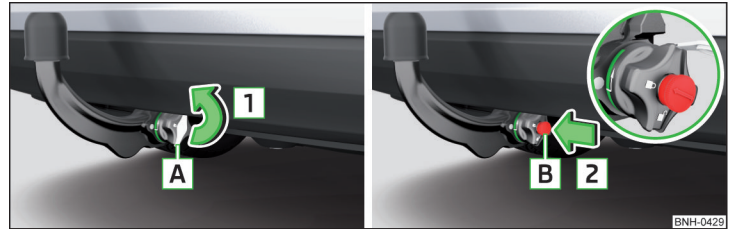
Abb. 128 Kappe vom Schloss abnehmen / Schlüssel in das Schloss stecken
