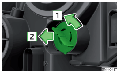
Abb. 176 Glühlampe für Blinklicht vorn wechseln
