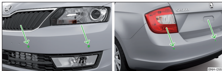
Abb. 107 Einbauort der Sensoren: vorn/hinten
