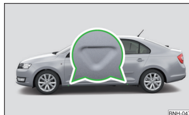
Abb. 153 Aufnahmepunkte für den Wagenheber
