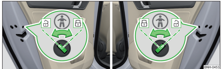
Abb. 38 Hintertür: Kindersicherung ein- / ausschalten
