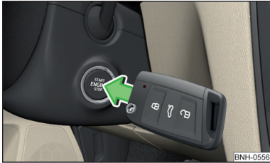
Abb. 96 Motor anlassen - Knopf mit dem Schlüssel drücken
