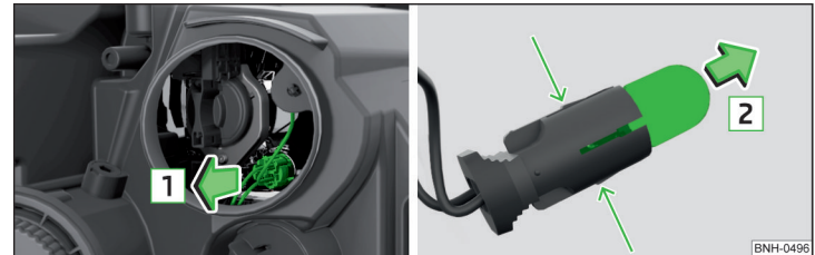
Abb. 175 Glühlampe für Standlicht wechseln
