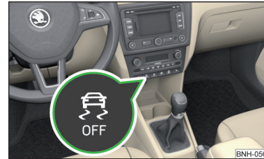
Abb. 106 Systemtaste: ASR deaktivieren/aktivieren
