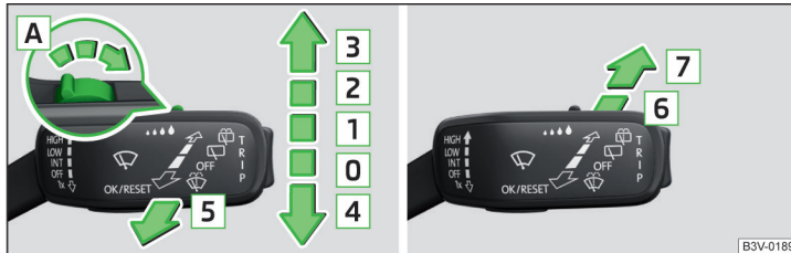
Abb. 53 Bedienung der Scheibenwischer und -wascher: vorn/hinten
