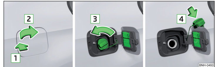
Abb. 134 Tankklappe aufklappen / Tankverschluss herausdrehen / Tankverschluss auf die Tankklappe stecken
