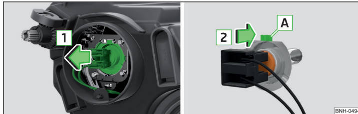
Abb. 173 Glühlampe für Abblendlicht wechseln
