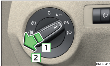
Abb. 47 Lichtschalter - Nebelscheinwerfer und Nebelschlussleuchte einschalten
