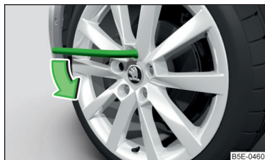
Abb. 152 Radwechsel: Radschrauben lösen
