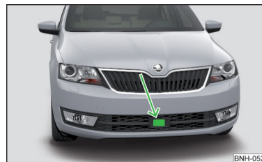
Abb. 115 Einbauort des Radarsensors
