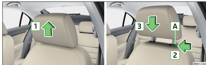
Abb. 57 Kopfstützen: nach oben verschieben / nach unten verschieben
