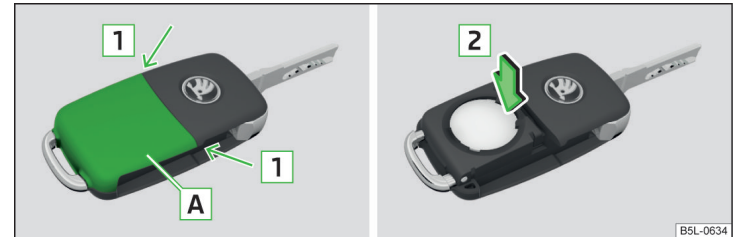
Abb. 161 Abdeckung abbauen / Batterie herausnehmen
