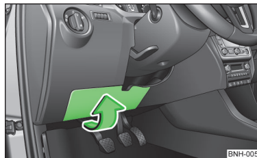
Abb. 165 Unterseite der Schalttafel: Abdeckung des Sicherungskastens
