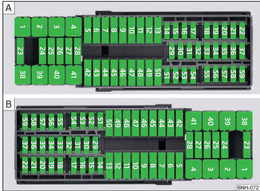
Abb. 265 Sicherungen: A - Linkslenkung / B - Rechtslenkung
