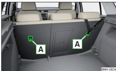
Abb. 28 Halteösen des TOP TETHER -Systems
