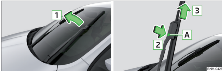
Abb. 261 Scheibenwischerblatt der Frontscheibe auswechseln
