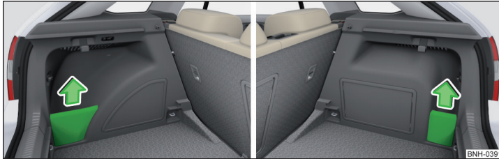
Abb. 108 Ablagefachabdeckung links/rechts abnehmen
