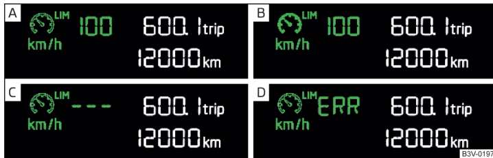
Abb. 210 Segmentdisplay: Beispiele für Zustandsanzeigen des Geschwindigkeitsbegrenzers
