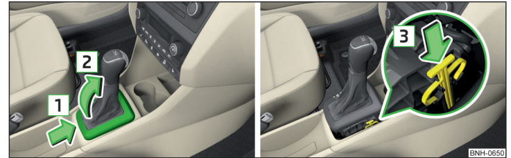
Abb. 259 Abdeckung abnehmen / Wählhebel entriegeln
