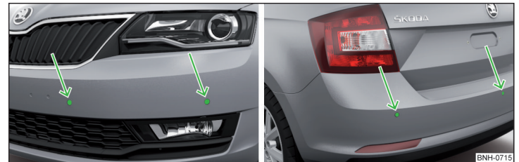
Abb. 199 Verbautort der Sensoren auf der linken Fahrzeugseite: vorn/hinten
