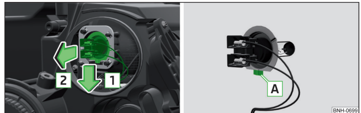
Abb. 274 Glühlampe für Fernlicht wechseln
