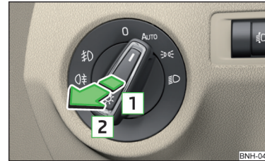
Abb. 57 Lichtschalter - Nebelscheinwerfer/Nebelschlussleuchte einschalten
