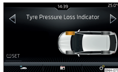
Abb. 215 Taste für Speicherung der Druckwerte / Beispiel der Bildschirmanzeige: das System weist auf eine Reifendruckänderung vorn rechts hin
