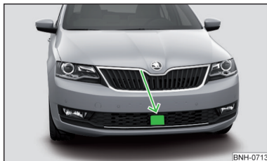
Abb. 197 Verbauort des Radarsensors
