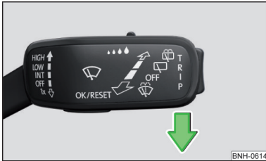
Abb. 260 Servicestellung der Scheibenwischerarme einstellen
