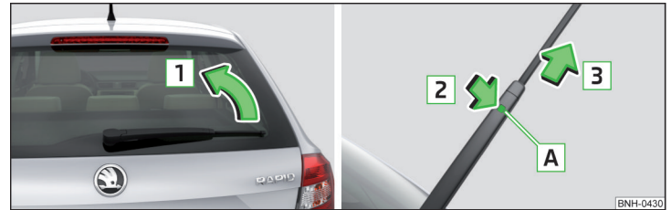
Abb. 262 Scheibenwischerblatt der Heckscheibe auswechseln
