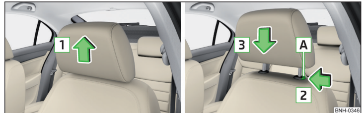
Abb. 72 Höhe der Kopfstütze einstellen
