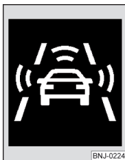
Abb. 213 Display des Kombi-Instruments: Vorwarnung bzw. Notbremsung bei niedriger Geschwindigkeit
