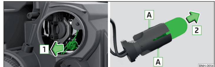
Abb. 271 Glühlampe für Standlicht wechseln
