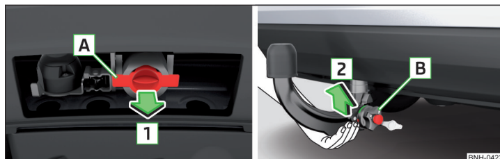
Abb. 220 Abdeckkappe für den Aufnahmeschacht abnehmen / Kugelstange einsetzen
