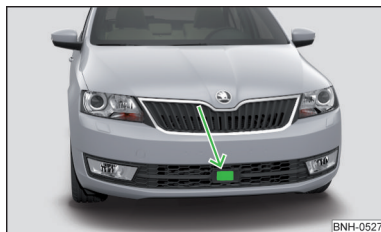
Abb. 131 Einbauort des Radarsensors
