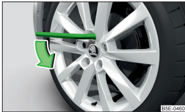
Abb. 168 Radwechsel: Radschrauben lösen
