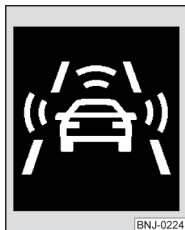
Abb. 133 Symbol im Display des Kombi-Instruments: Vorwarnung bzw. Notbremsung bei niedriger Geschwindigkeit
