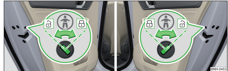
Abb. 40 Hintertür: Kindersicherung ein- / ausschalten
