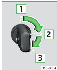
Abb. 110 Positionen des Fahrzeugschlüssels im Zündschloss
