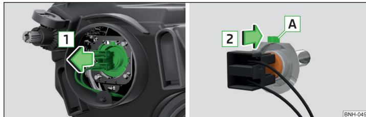
Abb. 189 Glühlampe für Abblendlicht wechseln
