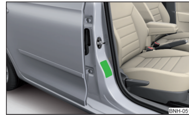
Abb. 13 Aufkleber an der B-Säule auf der Beifahrerseite
