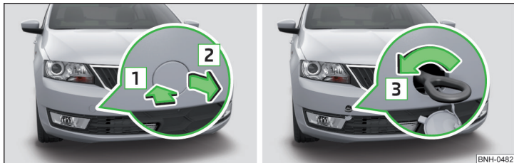
Abb. 175 Ausbau der Abdeckkappe / Einbau der Abschleppöse
