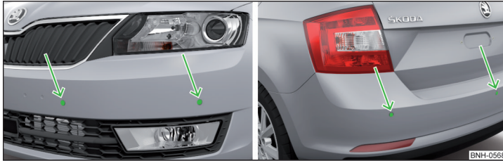
Abb. 123 Einbauort der Sensoren auf der linken Fahrzeugseite: vorn/hinten
