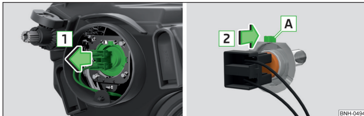
Abb. 181 Glühlampe für Abblendlicht wechseln
