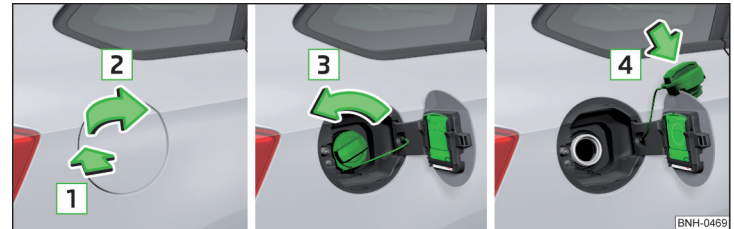
Abb. 142 Tankklappe aufklappen / Tankverschluss herausdrehen / Tankverschluss auf die Tankklappe stecken
