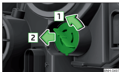
Abb. 184 Glühlampe für Blinklicht vorn wechseln
