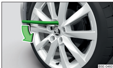
Abb. 160 Radwechsel: Radschrauben lösen
