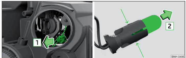
Abb. 183 Glühlampe für Standlicht wechseln
