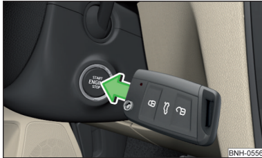
Abb. 104 Motor anlassen - Knopf mit dem Schlüssel drücken
