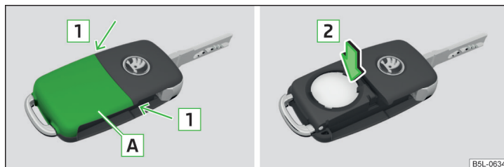
Abb. 169 Abdeckung abbauen / Batterie herausnehmen
