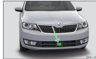
Abb. 123 Einbauort des Radarsensors
