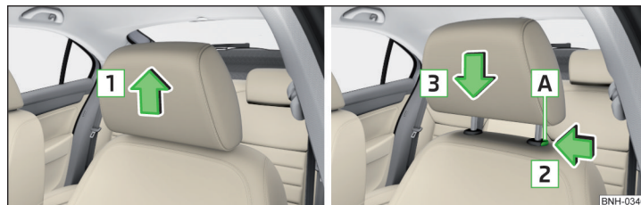
Abb. 58 Kopfstützen: nach oben verschieben / nach unten verschieben
