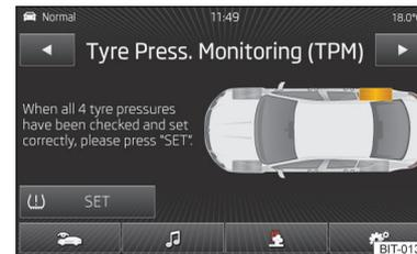
Abb. 54 Reifenkontrollanzeige - Darstellungsbeispiel: den Reifen hinten rechts und dessen Fülldruck prüfen
