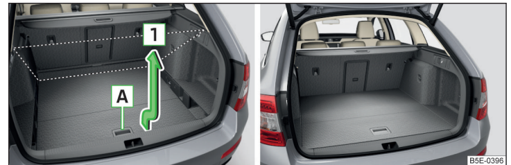
Abb. 142 Variablen Ladeboden in die obere Position einstellen / Variabler Ladeboden in der oberen Position
