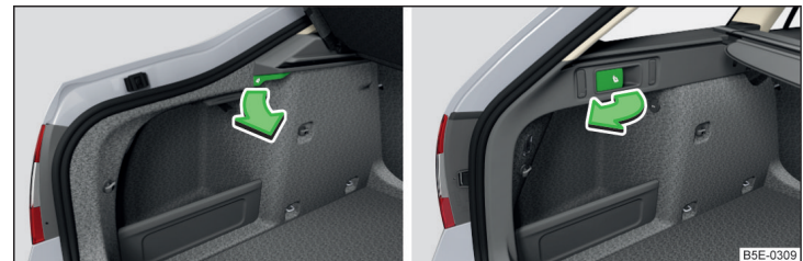
Abb. 87 Sitzlehne vom Gepäckraum aus vorklappen: Variante 1 / Variante 2
