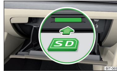
Abb. 183 Columbus, Amundsen, Bolero: SD-Karte einschieben
