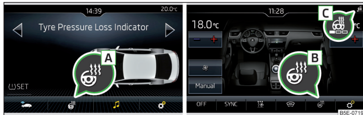
Abb. 93 Lenkradheizung: Manuelle Klimaanlage / Climatronic
