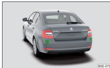
Abb. 257 Verbauport der Radarsensoren
