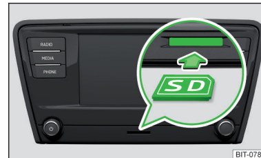
Abb. 184 Swing: SD-Karte einschieben
