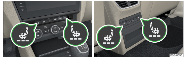
Abb. 92 Tasten für die Beheizung der Vordersitze / Rücksitze
