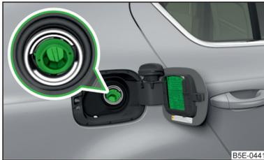
Abb. 304 Kraftstoffeinfüllstutzen bei Fahrzeugen mit Dieselmotoren
