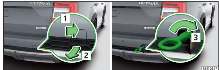
Abb. 331 Abdeckkappe abnehmen / Abschleppöse einbauen - Variante 2
