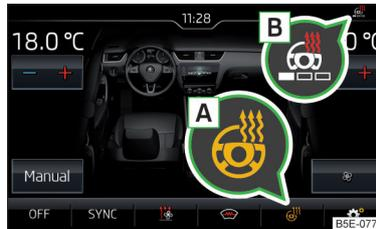
Abb. 76 Funktionsfläche für die Lenkradheizung
