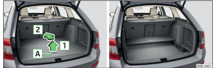
Abb. 127 Variablen Ladeboden zusammenklappen / Zusammengeklappter variabler Ladeboden in der oberen Position
