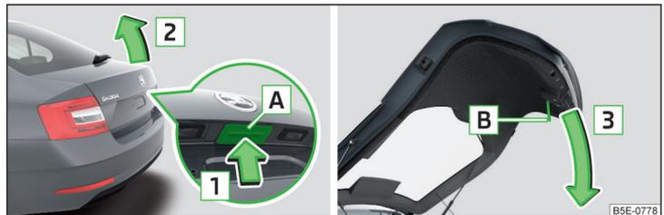
Abb. 39 **Gepäckraumklappe öffnen/schließen**
