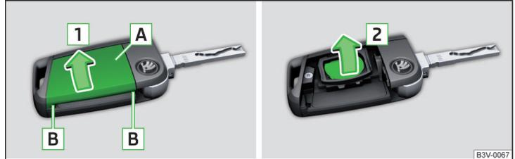
Abb. 332 Abdeckung aufklappen / Batterie herausnehmen
