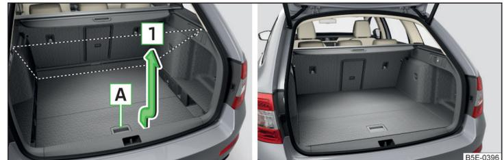
Abb. 125 Variablen Ladeboden in die obere Position einstellen / Variabler Ladeboden in der oberen Position
