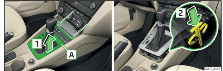
Abb. 338 Abdeckung lösen / Wählhebel entriegeln
