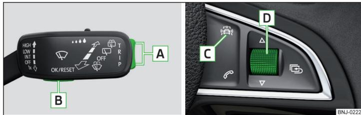
Abb. 278 Tasten/Einstellrad: am Bedienungshebel / am Multifunktionslenkrad
