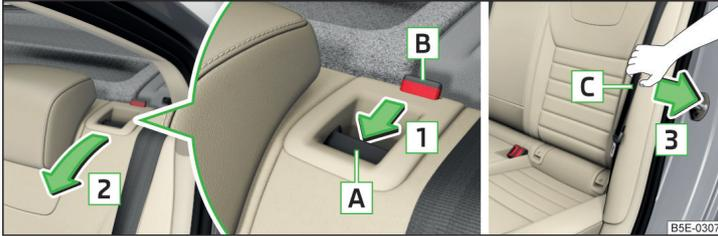
Abb. 69 Sitzlehne vom Fahrgastraum aus vorklappen / Gurt zur Seitenverkleidung ziehen
