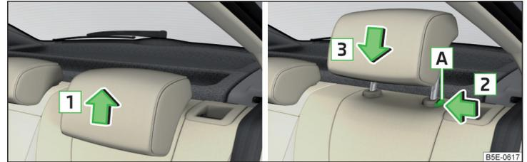
Abb. 73 Höhe der Kopfstütze hinten einstellen
