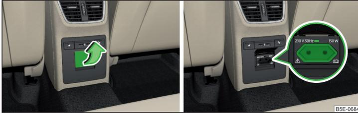
Abb. 98 Abdeckung der 230-Volt-Steckdose aufklappen / 230-Volt-Steckdose
