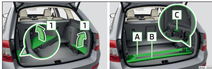
Abb. 133 **Seitenabdeckungen des Gepäckraums herausnehmen / Dachgepäckträger verstauen**
