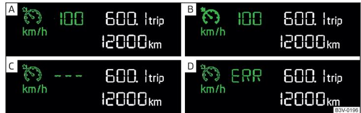
Abb. 265 Segmentdisplay: Beispiele für Zustandsanzeigen der GRA
