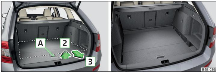
Abb. 126 Variablen Ladeboden in die untere Position einstellen / Variabler Ladeboden in der unteren Position
