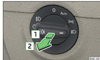
Abb. 51 Lichtschalter - Nebelscheinwerfer/Nebelschlussleuchte einschalten
