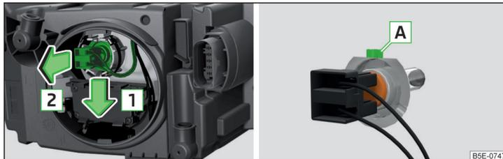
Abb. 349 Glühlampe für Abblendlicht wechseln
