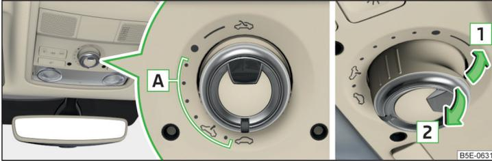
Abb. 44 Bedienung des Schiebe-/Ausstelltdachs
