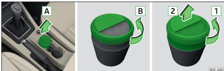
Abb. 99 Aschenbecher herausnehmen / öffnen / zerlegen
