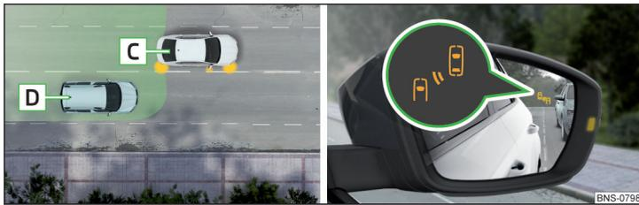
Abb. 249 Fahrsituation / Kontrollleuchte im rechten Außenspiegel weist auf die Fahrsituation hin
