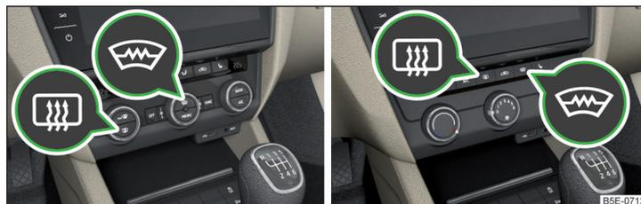
Abb. 57 Tasten für die Front- und Heckscheibenbeheizung: Climatronic / Manuelle Klimaanlage
