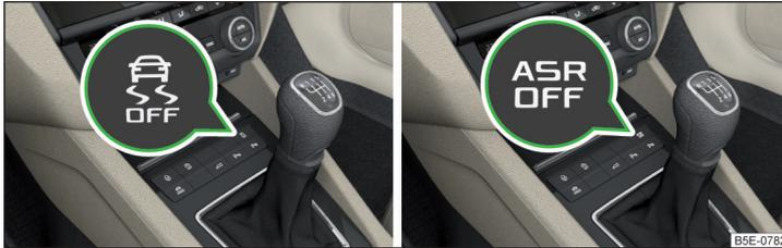
Abb. 239 Systemtaste: Fahrzeug mit ESC / Fahrzeug ohne ESC
