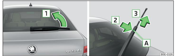
Abb. 341 **Scheibenwischerblatt der Heckscheibe auswechseln**
