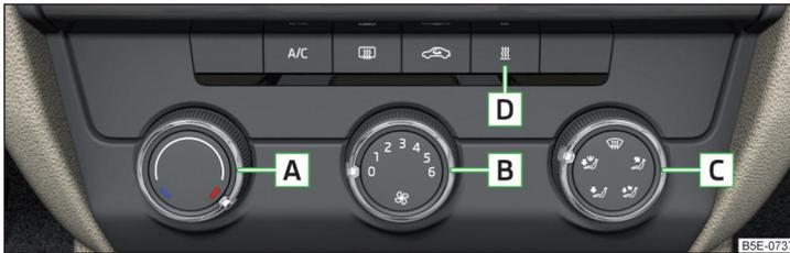
Abb. 134 Bedienelemente der Heizung/Klimaanlage
