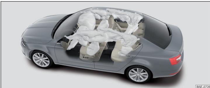
Abb. 9 Gasgefüllte Airbags
