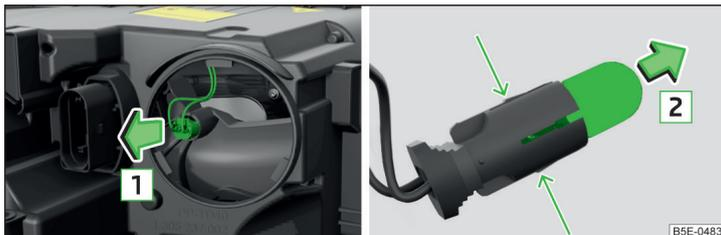
Abb. 246 Scheinwerfer mit Xenon-Licht: Glühlampe für zusätzliches
