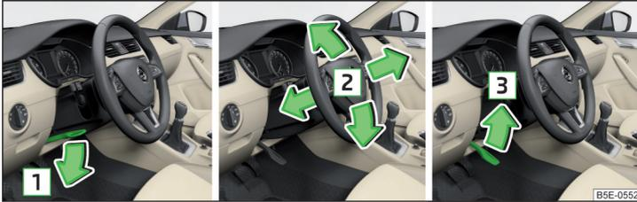
Abb. 3 Lenkradposition einstellen
