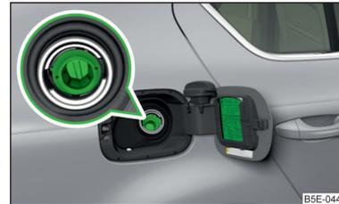
Abb. 200 Kraftstoffeinfüllstutzen bei Fahrzeugen mit Dieselmotoren
