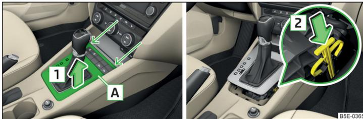
Abb. 235 Wählhebel-Notentriegelung
