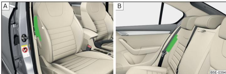
Abb. 11 Einbauorte der Airbags: im Vordersitz / hinten
