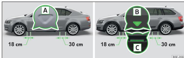
Abb. 221 **Aufnahmepunkte für den Wagenheber: Variante 1 / Variante 2**
