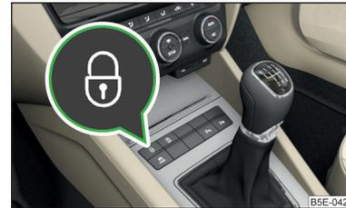
Abb. 40 Zentralverriegelungstaste
