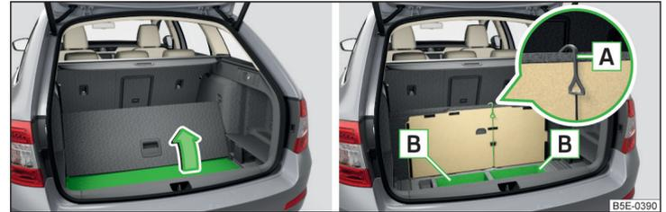
Abb. 124 Bodenbelag anheben / Ablagefächer unter dem Bodenbelag
