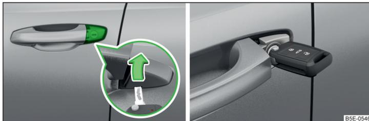
Abb. 232 Griff an der Fahrtür: abgedeckter Schließzylinder / Schließzylinder mit Schlüssel
