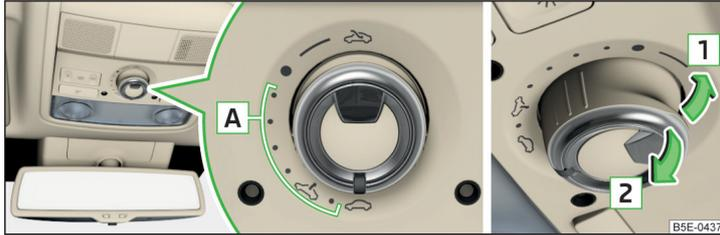
Abb. 50 Bedienung des Schiebe-/Ausstelldachs - Variante 1
