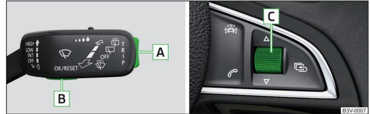
Abb. 30 Tasten/Einstellrad: am Bedienungshebel / am Multifunktionslenkrad
