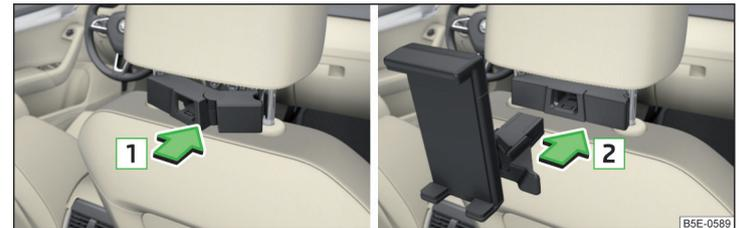
Abb. 105 Adapter anbringen / Halter einbauen
