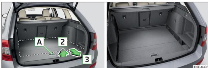
Abb. 127 Variablen Ladeboden in die untere Position einstellen / Variabler Ladeboden in der unteren Position
