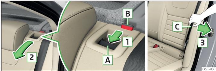
Abb. 81 Sitzlehne vom Innenraum aus vorklappen / Gurt zur Seitenverkleidung ziehen
