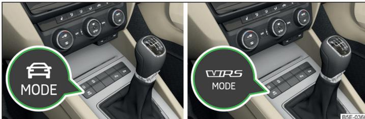
Abb. 176 Taste für die Auswahl des Fahrmodus: Variante 1 / Variante 2
