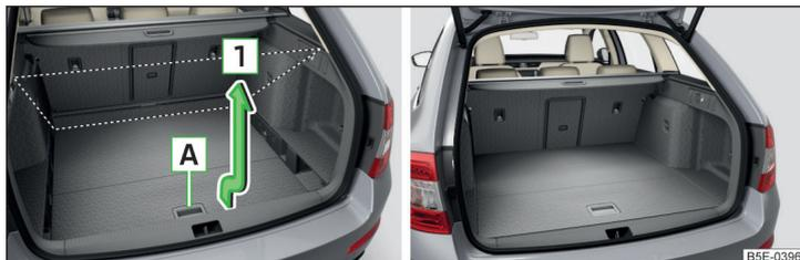
Abb. 126 Variablen Ladeboden in die obere Position einstellen / Variabler Ladeboden in der oberen Position
