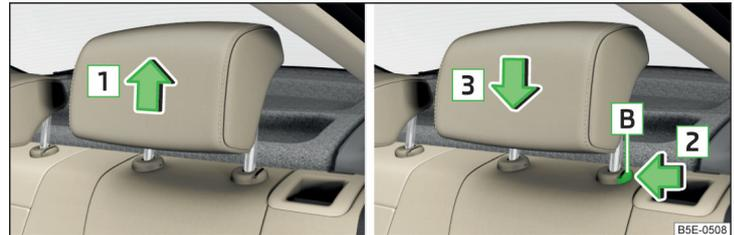
Abb. 74 Kopfstütze hinten: nach oben verschieben / nach unten verschieben
