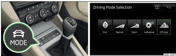
Abb. 156 Taste für die Auswahl des Fahrmodus / Funktionstaste im Infotainmentdisplay
