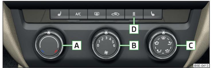
Abb. 136 Bedienelemente der manuellen Klimaanlage
