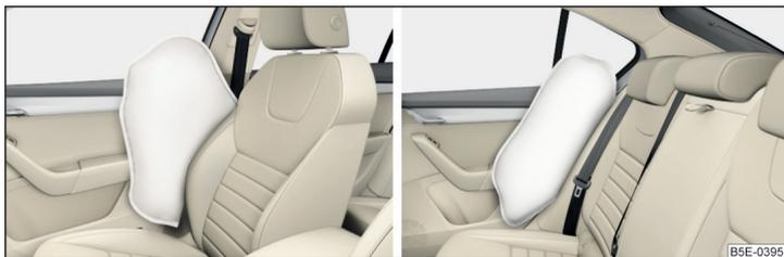
Abb. 12 Gasgefüllte Airbags
