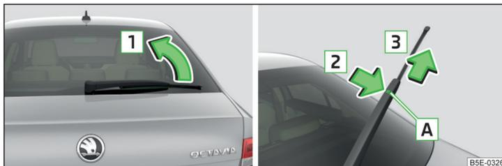
Abb. 237 Scheibenwischerblatt der Heckscheibe
