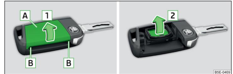
Abb. 230 Abdeckung abbauen / Batterie herausnehmen
