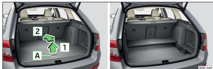
Abb. 128 Variablen Ladeboden zusammenklappen / Zusammengeklappter variabler Ladeboden in der oberen Position
