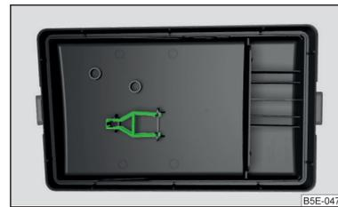
Abb. 242 Abdeckung des Sicherungskastens im Motorraum: Kunststoffklammer für Sicherungen
