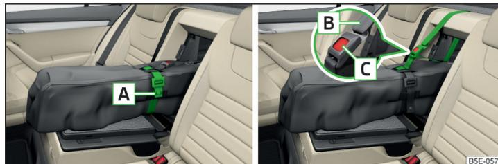
Abb. 103 Band anziehen / Durchladesack sichern
