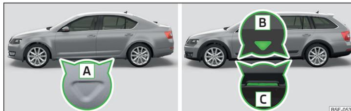
Abb. 214 Aufnahmepunkte für den Wagenheber: Variante 1 / Variante 2
