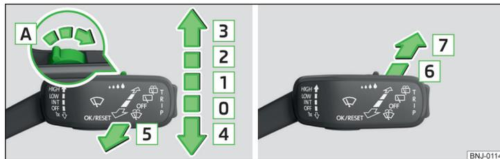
Abb. 66 Bedienung der Scheibenwischer und -wascher: vorn/hinten
