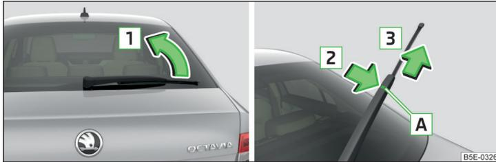
Abb. 230 Scheibenwischerblatt der Heckscheibe
