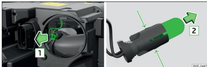
Abb. 239 Scheinwerfer mit Xenon-Licht: Glühlampe für zusätzliches Standlicht
