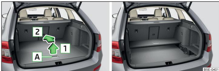
Abb. 120 Variablen Ladeboden zusammenklappen / Zusammengeklappter variabler Ladeboden in der oberen Position
