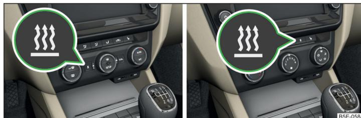
Abb. 132 Taste für direktes Ein-/Ausschalten der Zusatzheizung (Standheizung und -lüftung) auf dem Bedienteil der Climatic / manuellen Klimaanlage
