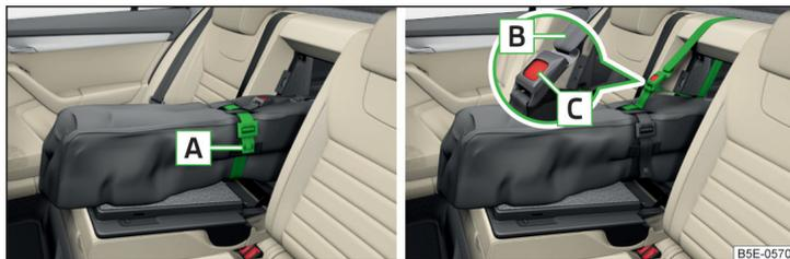
Abb. 100 Band anziehen / Durchladesack sichern
