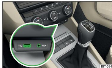
Abb. 101 Einbauorte der AUX- und USB-Eingänge
