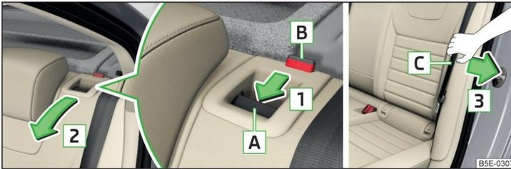
Abb. 79 Sitzlehne entriegeln und vorklappen / Gurt zur Seitenverkleidung ziehen
