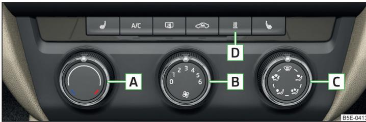
Abb. 128 Bedienungselemente der manuellen Klimaanlage
