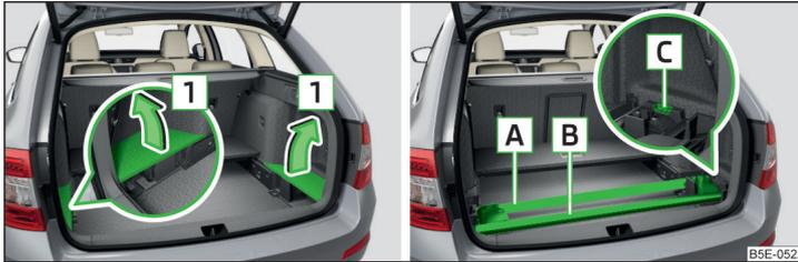
Abb. 126 Seitenabdeckungen des Gepäckraums herausnehmen / Dachgepäckträger verstauen
