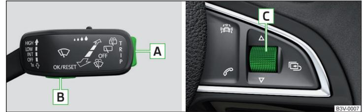
Abb. 29 Tasten/Einstellrad: am Bedienungshebel / am Multifunktionslenkrad
