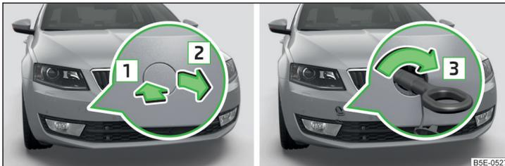
Abb. 220 Ausbau der Abdeckkappe / Einbau der Abschleppöse
