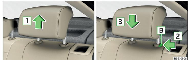
Abb. 72 Kopfstütze hinten: nach oben verschieben / nach unten verschieben
