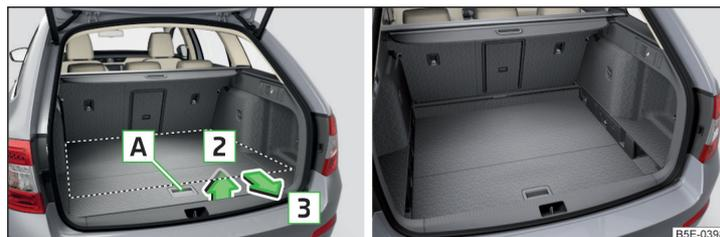
Abb. 119 Variablen Ladeboden in die untere Position einstellen / Variabler Ladeboden in der unteren Position
