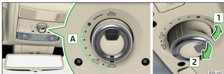
Abb. 48 Bedienung des Schiebe-/Ausstelltdachs - Variante 1
