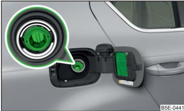
Abb. 193 Kraftstoffeinfüllstutzen bei Fahrzeugen mit Dieselmotoren
