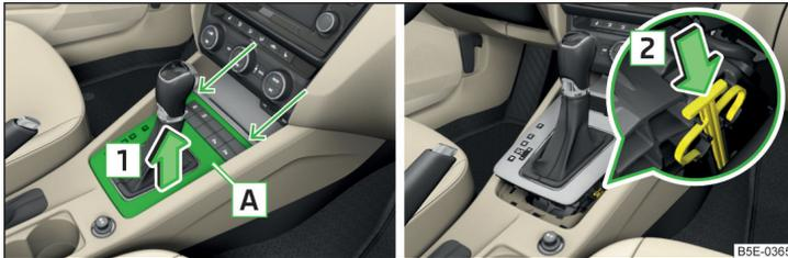
Abb. 228 Wählhebel-Notentriegelung
