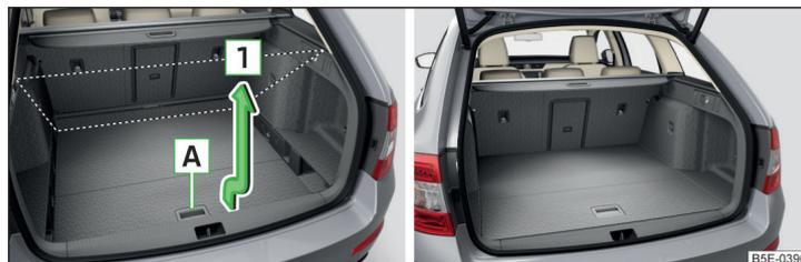
Abb. 118 Variablen Ladeboden in die obere Position einstellen / Variabler Ladeboden in der oberen Position
