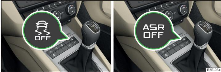
Abb. 146 Systemtaste: Fahrzeug mit ESC / Fahrzeug ohne ESC
