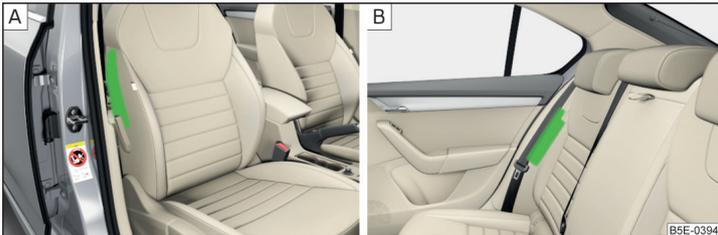
Abb. 10 Einbauorte der Airbags: im Vordersitz / hinten
