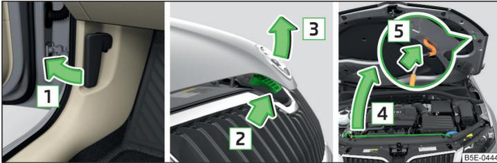
Abb. 196 Motorraumklappe öffnen
