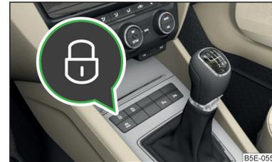
Abb. 38 Zentralverriegelungstaste
