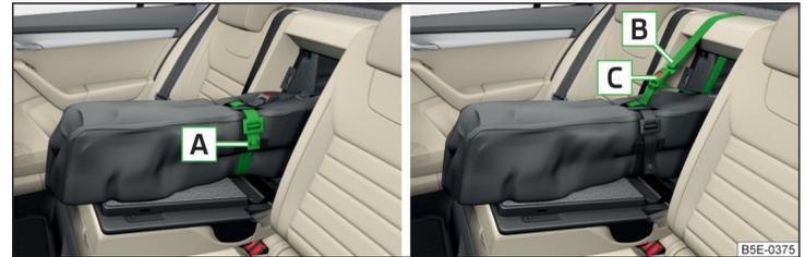
Abb. 95 Band anziehen / Durchladesack sichern
