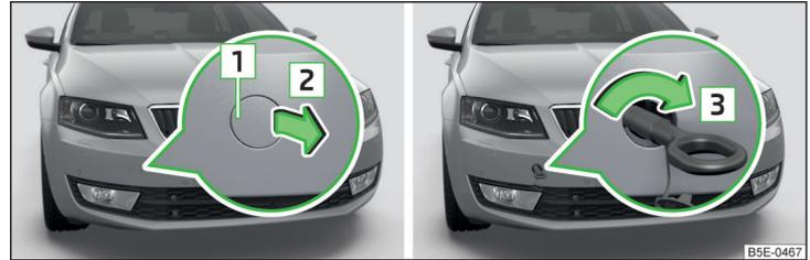
Abb. 203 Ausbau der Abdeckkappe / Einbau der Abschleppöse
