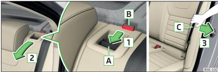
Abb. 74 Sitzlehne entriegeln / Gurt zur Seitenverkleidung ziehen
