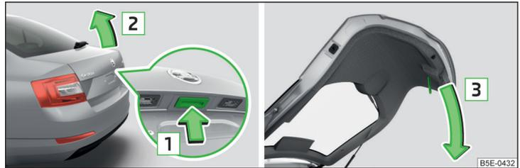
Abb. 39 Gepäckraumklappe öffnen/schließen
