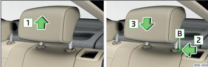
Abb. 67 Höhe der Kopfstütze hinten einstellen
