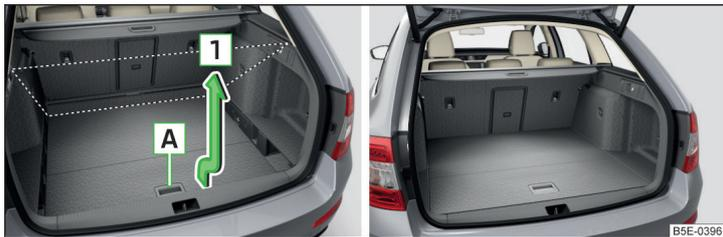
Abb. 111 Variablen Ladeboden in die obere Position einstellen / Variabler Ladeboden in der oberen Position
