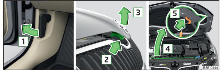
Abb. 177 Motorraumklappe
