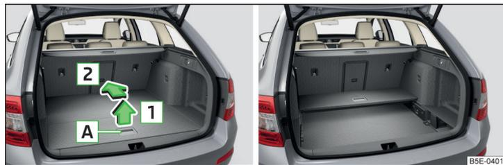
Abb. 113 Variablen Ladeboden zusammenklappen / Zusammengeklappter variabler Ladeboden in der oberen Position
