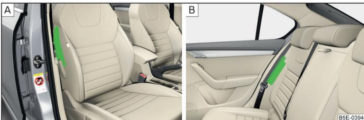
Abb. 11 Einbauort des Airbags im Vorder-/Rücksitz
