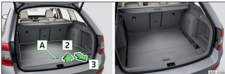
Abb. 112 Variablen Ladeboden in die untere Position einstellen / Variabler Ladeboden in der unteren Position
