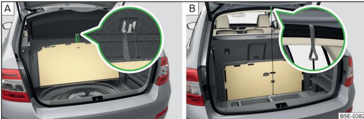
Abb. 102 Bodenbelag befestigen: Variante 1 / Variante 2
