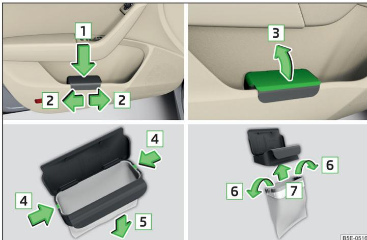
Abb. 86 Abfallbehälter: einsetzen und verschieben / öffnen / Beutel ersetzen
