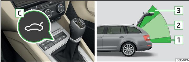
Abb. 41 Taste für die Klappenbedienung / Bedienungsbereiche
