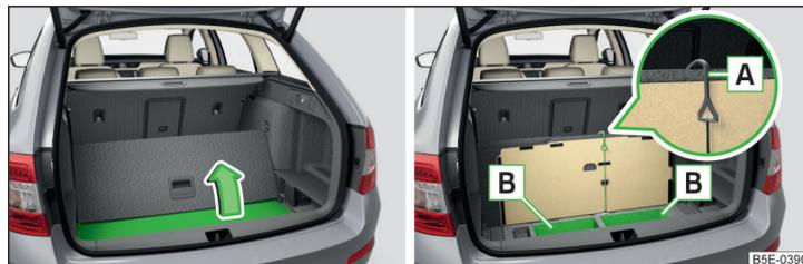
Abb. 109 Bodenbelag anheben / Ablagefächer unter dem Bodenbelag
