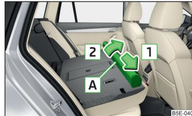
Abb. 117 Netztrennwandgehäuse ausbauen
