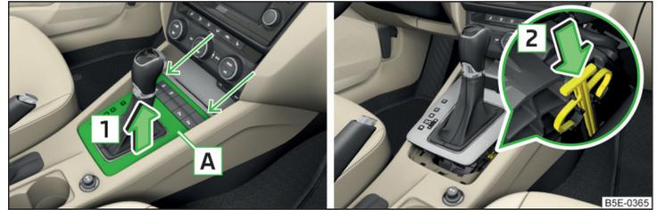
Abb. 211 Wählhebel-Notentriegelung
