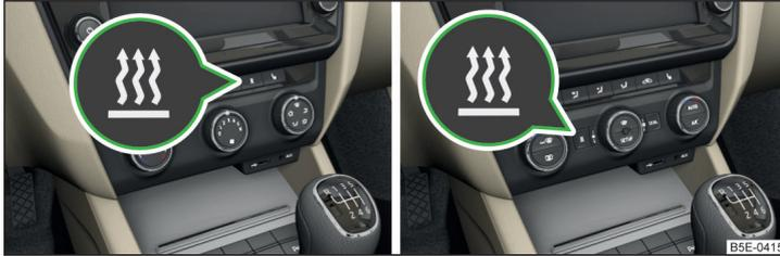
Abb. 124 Taste für direktes Ein-/Ausschalten auf dem Bedienteil der Klimaanlage / Climatronic
