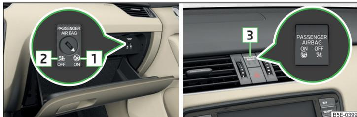
Abb. 14 Schlüsselschalter für Beifahrer-Frontairbag / Kontrollleuchte für Beifahrer-Frontairbagab/-einschaltung
