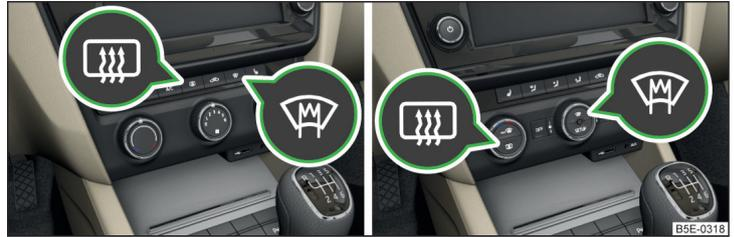
Abb. 58 Tasten für die Front- und Heckscheibenbeheizung manuelle Klimaanlage, Heizung / Climatronic
