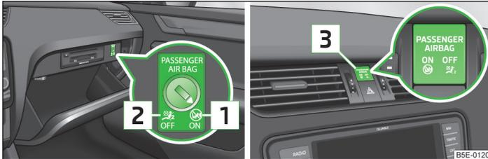
Abb. 170 Schlüsselschalter für Beifahrer-Frontairbag / Kontrollleuchte für Beifahrer-Frontairbagab-/einschaltung
