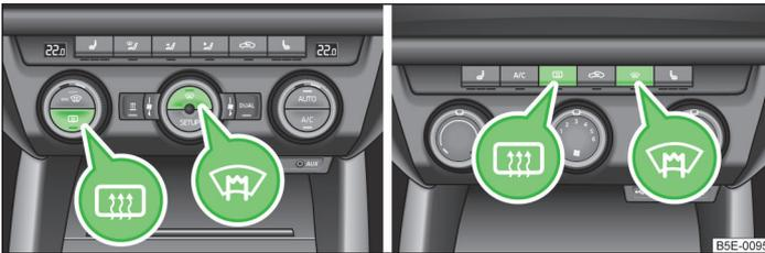
Abb. 39 Tasten für die Front- und Heckscheibenbeheizung Climatronic/manuelle Klimaanlage, Heizung
