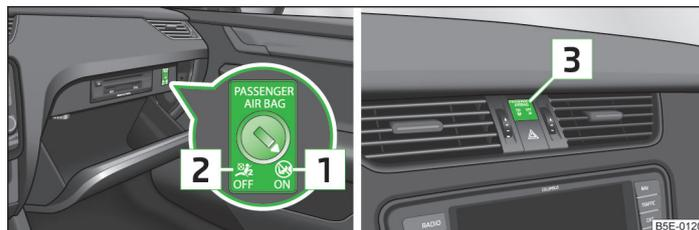
Abb. 137 Schlüsselschalter für Beifahrer-Frontairbag / Kontrollleuchte für Beifahrer-Frontairbagab-/einschaltung
