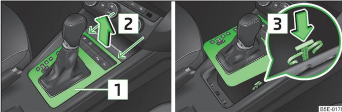
Abb. 122 Wählhebel-Notentriegelung
