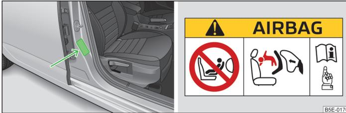
Abb. 139 Aufkleber an der B-Säule auf der Beifahrerseite / Warnschild
