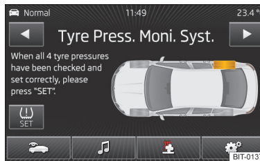
Abb. 27 Reifendruckanzeige - Darstellungsbeispiel: das System weist auf eine Reifendruckänderung hinten rechts hin
