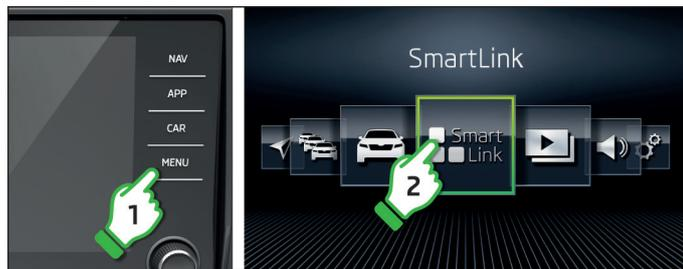
Die Funktion SmartLink+ bietet die Möglichkeit an, zertifizierte Anwendungen eines externen mittels USB angeschlossenen Geräts im Gerätebildschirm anzuzeigen und zu bedienen.
