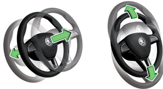
Die Lenkradposition kann in Längsrichtung und in Höhe verstellt werden.
