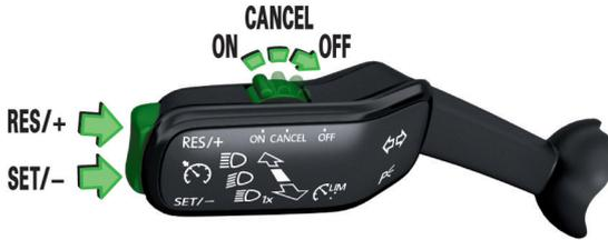
Die Geschwindigkeitsregelanlage regelt die eingestellte Geschwindigkeit, ohne dass das Gaspedal betätigt werden muss. Während der Regelung leuchtet im Kombi-Instrument die Kontrollleuchte
