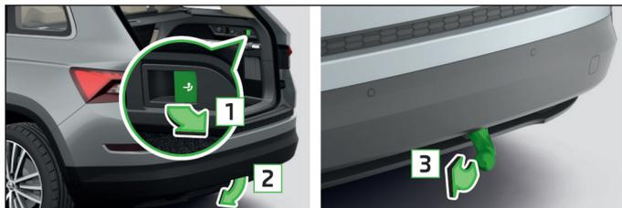
➤ Am Schalter in Pfeilrichtung **1** ziehen (der Verbauplatz des Schalters kann ausstattungsabhängig unterschiedlich sein).
