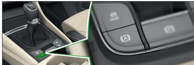
Die Auto Hold Funktion sichert das Fahrzeug beim Anhalten gegen Wegrollen. Die Sicherung des Fahrzeugs wird durch Aufleuchten der Kontrollleuchte
