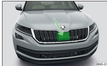
Abb. 263 Verbautort des Radarsensors
