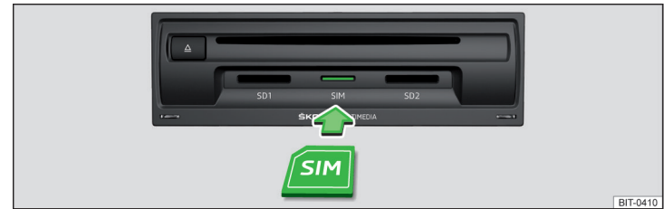
Abb. 209 SIM-Karte in das externe Modul einstecken
