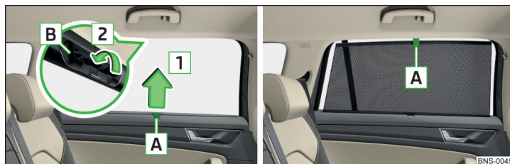
Abb. 82 Sonnenschutzrollo in der hinteren Tür
