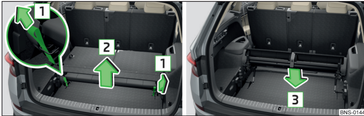
Abb. 98 Sitze hochklappen/herunterklappen
