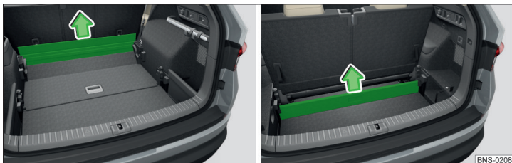
Abb. 163 Trennwand abnehmen: Fünfsitzer-Variante/ Siebensitzer-Variante
