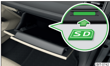
Abb. 199 Columbus, Amundsen, Bolero: SD-Karte einschieben
