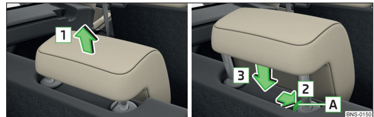
Abb. 104 Höhe der Kopfstütze der dritten Sitzreihe einstellen
