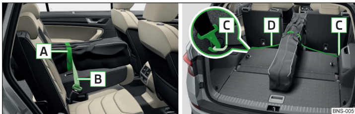
Abb. 133 Durchladesack vorn/hinten sichern
