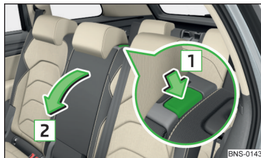
Abb. 96 Mittlere Sitzlehne vorklappen
