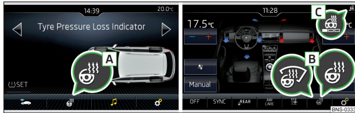
Abb. 109 Lenkradheizung: Manuelle Klimaanlage / Climatronic
