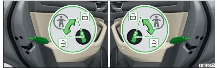
Abb. 60 Hintertür: Kindersicherung ein- / ausschalten
