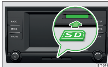
Abb. 200 Swing: SD-Karte einschieben
