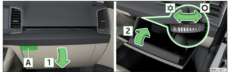
Abb. 115 Ablagefach öffnen / Ablagefach schließen und Luftzufuhr bedienen
