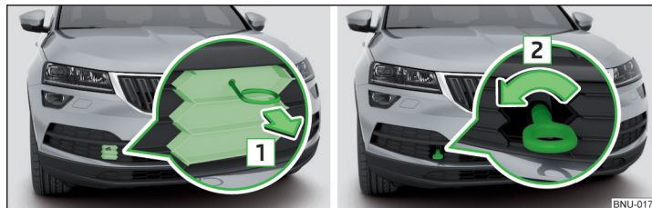
Abb. 327 Schutzgitter abnehmen / Abschleppöse einbauen
