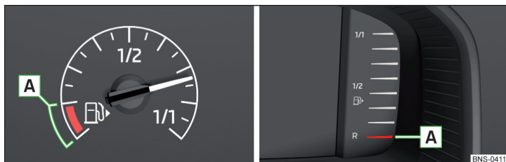
Abb. 32 Kraftstoffvorratsanzeige: Variante 1 / Variante 2
