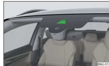
Abb. 293 Sensor für die Verkehrszeichenerkennung
