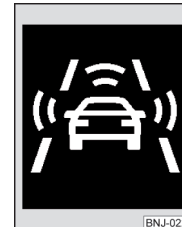
Abb. 288 Display des Kombi-Instruments: Vorwarnung bzw. Notbremsung bei niedriger Geschwindigkeit
