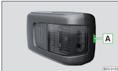
Abb. 331 Arretierungsclip an der Akkuabdeckung
