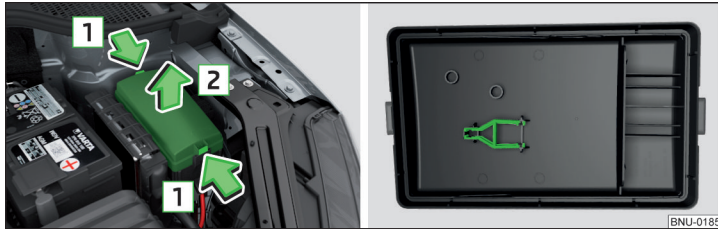
Abb. 343 Abdeckung des Sicherungskastens: Abdeckung abnehmen / Kunststoffklammer für Sicherungen
