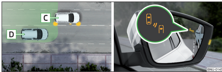
Abb. 268 Fahrsituation / Kontrollleuchte im rechten Außenspiegel weist auf die Fahrsituation hin
