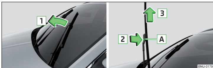
Abb. 337 Scheibenwischerblatt der Frontscheibe auswechseln
