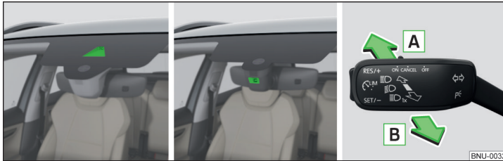
Abb. 64 Verbauortvarianten des Sensors / System ein-/ausschalten
