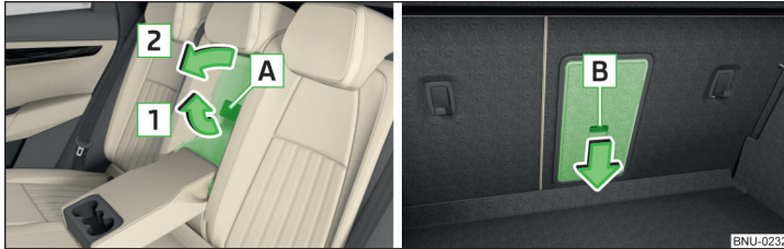
Abb. 122 Deckel öffnen: vom Fahrgastraum aus / vom Gepäckraum aus
