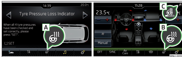
Abb. 99 Lenkradheizung: Manuelle Klimaanlage / Climatronic
