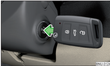
Abb. 244 Motor anlassen - Schlüssel an den Knopf halten
