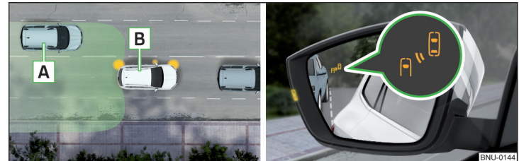
Abb. 267 Fahrsituation / Kontrollleuchte im linken Außenspiegel weist auf die Fahrsituation hin
