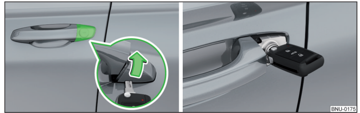
Abb. 332 Griff an der Fahrtür: Schlossabdeckung aufklappen / Schließzylinder mit Schlüssel
