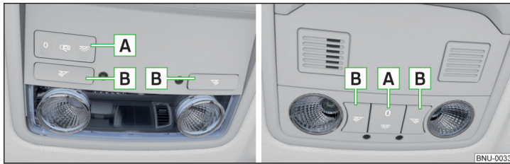
Abb. 68 Bedienung der Leuchte vorn: Variante 2 / Variante 3
