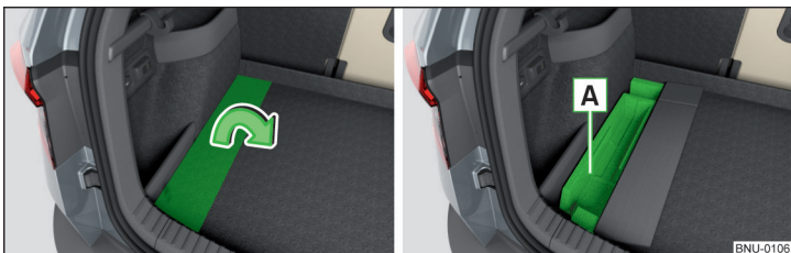
Abb. 150 Variante 1: Bodenbelag umklappen / Ablagefach unter dem Bodenbelag
