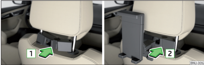
Abb. 131 Einsetzen: Adapter / Halter
