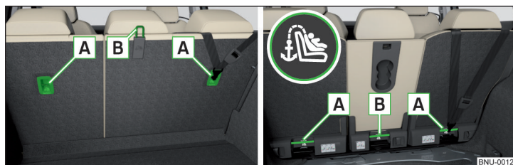
Abb. 28 Halteösen des TOP TETHER-Systems: Variante 1 / Variante 2
