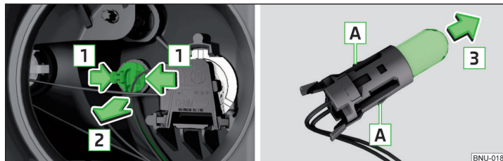
Abb. 347 Glühlampe für Standlicht wechseln
