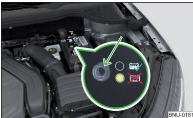
Abb. 310 Fahrzeugbatterie: Säurestands- anzeige
