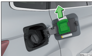
Abb. 299 Verbauort des Eiskratzers, Eiskratzer abnehmen
