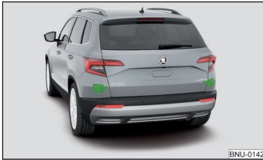
Abb. 265 Verbauort der Radarsensoren
