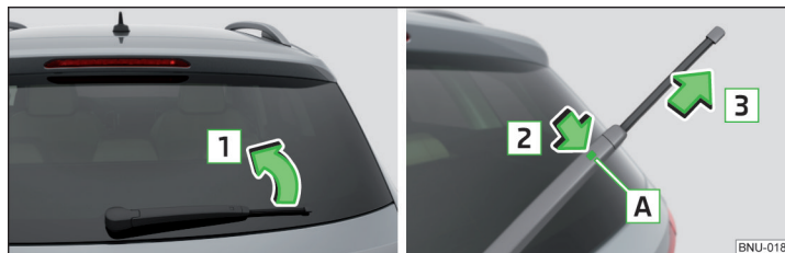
Abb. 338 Scheibenwischerblatt der Heckscheibe auswechseln
