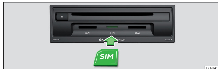
Abb. 197 SIM-Karte in das externe Modul einstecken
