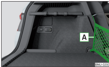
Abb. 138 Befestigungsbeispiele für Netze: Variante 3
