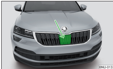
Abb. 256 Verbautort des Radarsensors
