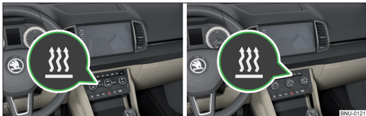
Abb. 162 Taste für das Ein-/Ausschalten (Climatronic / manuelle Klimaanlage)
