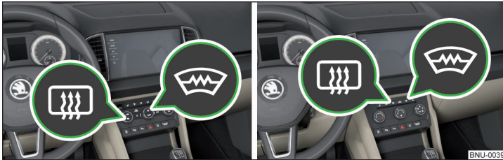
Abb. 72 Tasten für die Front- und Heckscheibenbeheizung: Climatronic / Manuelle Klimaanlage
