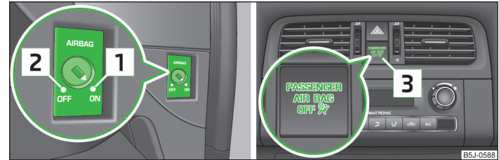
Abb. 117 Schlüsselschalter für Beifahrer-Frontairbag / Kontrollleuchte für Beifahrer-Frontairbagab-/einschaltung
