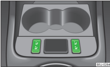
Abb. 40 Wippschalter für Sitzheizung vorn
