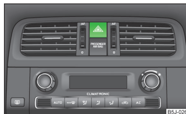
Abb. 27 Schalttafel: Schalter für Warnblinkanlage
