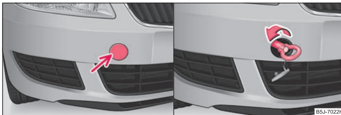
Abb. 159 Vorderer Stoßfänger: Abdeckung / Einbau der Abschleppöse
