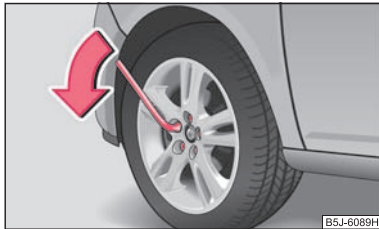
Abb. 154 Radwechsel: Radschrauben lockern
