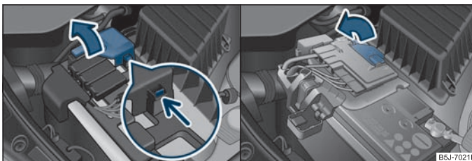
Abb. 144 Batterie: Abdeckung hochklappen (automatisches Getriebe) / (Schaltgetriebe)
