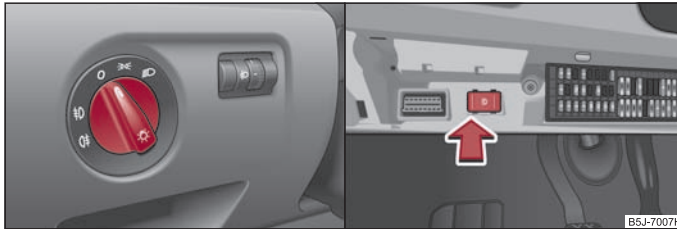
Abb. 36 Schalttafel: Lichtschalter / Sicherungsfach: Schalter für Tagfahrlicht
