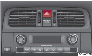
Abb. 39 Schalttafel: Schalter für Warnblinkanlage
