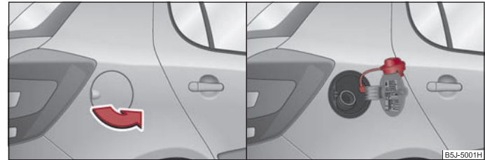
Abb. 11 Fahrzeugseite hinten rechts: Tankklappe / Tankklappe mit abgeschraubtem Verschluss
