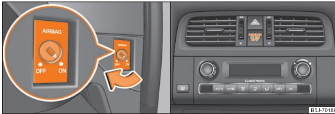
Abb. 121 Schalter für Front-Beifahrer-Airbag / Kontrollleuchte für Beifahrer-Airbagabschaltung
