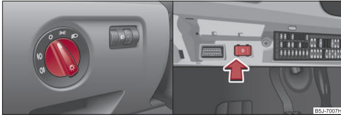
Abb. 35 Schalttafel: Lichtschalter / Sicherungsfach: Schalter für Tagfahrlicht
