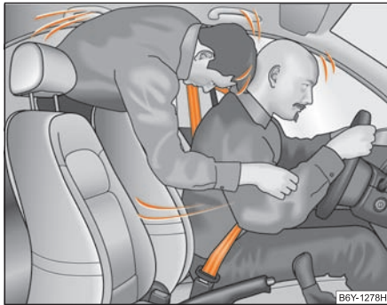
Abb. 143 Der nicht angegurte Mitfahrer auf dem Rücksitz fliegt nach vorn
