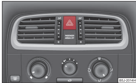
Abb. 52 Schalttafel: Schalter für Warnblinkanlage
