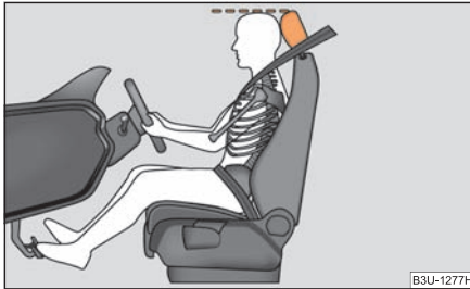
Abb. 140 Die richtige Kopf- stützeneinstellung des Fahrers
