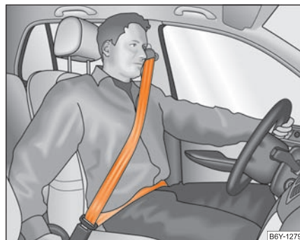
Abb. 144 Gurtbandverlauf des Schulter- und Beckengurtes
