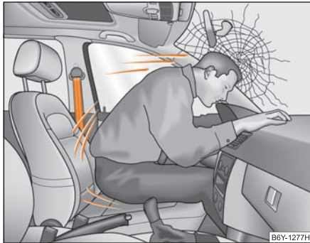
Abb. 142 Der nicht angegurte Fahrer fliegt nach vorn
