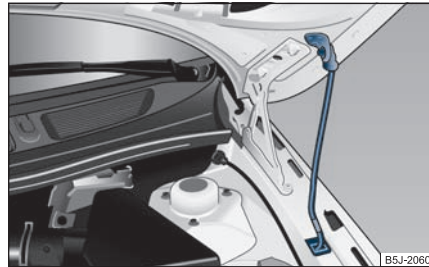
Abb. 180 Sicherung der Motorraumklappe mit der Klappenstütze
