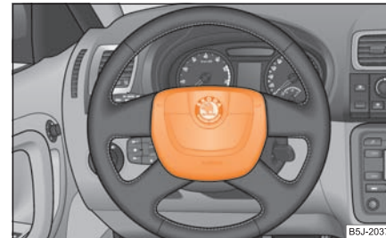
Abb. 148 Fahrer-Airbag im Lenkrad
