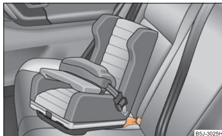
Abb. 166 Der ISOFIX-Kindersitz wird in die montierten Aufnahme-trichter geschoben
