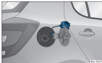
Abb. 177 Tankklappe mit abgeschraubtem Verschluss
