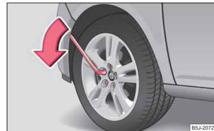
Abb. 196 Radwechsel: Radschrauben lockern
