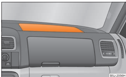
Abb. 149 Beifahrer-Airbag in der Schalttafel
