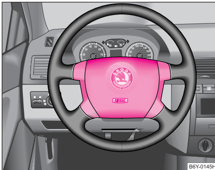
Abb. 109 Fahrer-Airbag im Lenkrad
