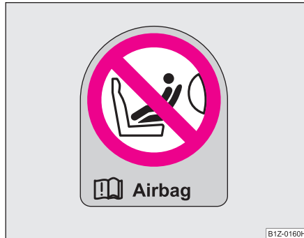
Abb. 117 Aufkleber an der Mittelsäule der Karosserie auf der Beifahrerseite
