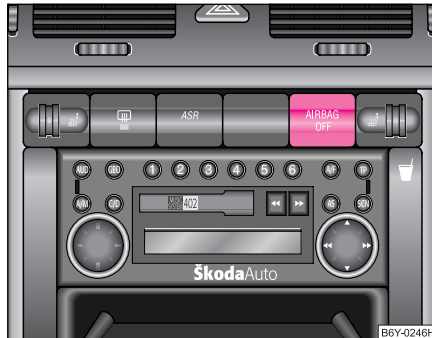
Abb. 116 Kontroll- leuchte für Beifahrer- Airbagabschaltung
