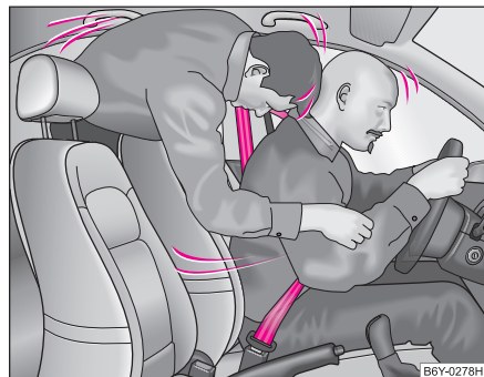
Abb. 102 Der nicht angegurte Mitfahrer auf dem Rücksitz fliegt nach vorn
