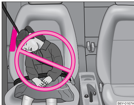
Abb. 118 Das nicht richtig gesicherte Kind in nicht richtiger Sitzposition - gefährdet durch den Seiten-Airbag
