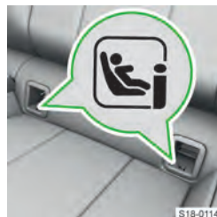
Halteösen für den Einbau des Kindersitzes mit dem ISOFIX-System.
