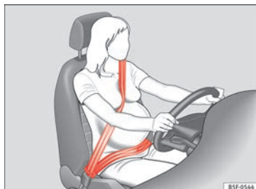
Abb. 79 Gurtbandverlauf im Brust- und Beckenbereich und bei schwangeren Frauen.
