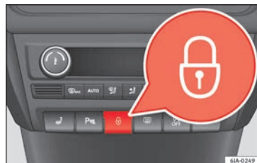
Abb. 121 Taster für Zentralverriegelung
