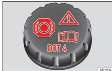
Abb. 52 Motorraum: Deckel des Bremsflüssigkeitsbehälters
