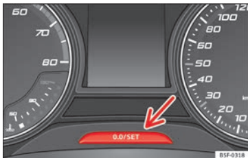
Abb. 111 Kombi-Instrument: Kilometerzähler und Rückstelltaste.
