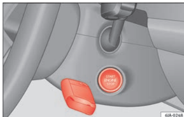
Abb. 174 Notstart bei Fahrzeugen mit Keyless Access.
