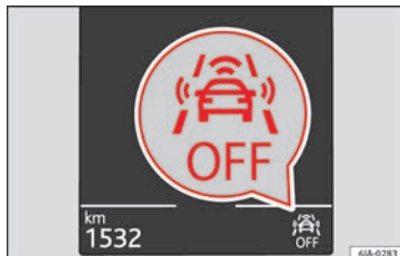
Abb. 190 Auf dem Display des Kombi-Instrumenten: Anzeige, dass Front Assist ausgeschaltet ist.
