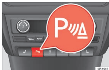
Abb. 182 Mittelkonsole: Taste für Einparkhilfe.
