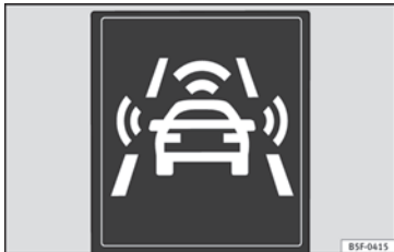
Abb. 192 Im Display des Kombiinstrumentes: Anzeige der Vorwarnung.
