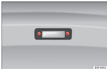
Abb. 107 Ausbau der Kennzeichenleuchte
