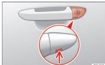
Abb. 3 Fahrtürgriff: verborgener Schließzylinder.
