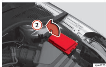
Abb. 87 Im Motorraum: Abdeckung des Sicherungskastens - Variante 2
