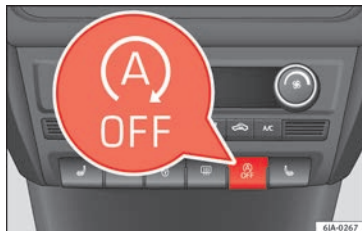
Abb. 193 Kombiinstrument: Taste für Start-Stop-System.
