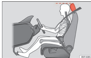
Abb. 72 Die richtige Kopfstützeinstellung des Fahrers.
