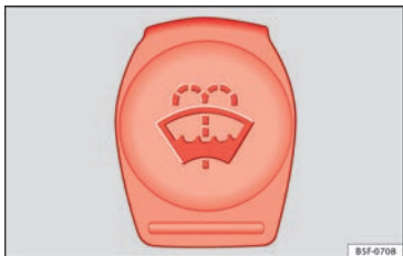
Abb. 53 Im Motorraum: Deckel des Scheibenwaschbehälters.
