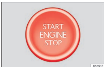
Abb. 173 In der Lenksäule: Starterknopf des schlüssellosen Schließ- und Startsystem Keyless Access. Bei Rechtslenker-Fahrzeugen ist die Anordnung symmetrisch.
