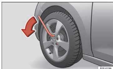
Abb. 62 Radwechsel: Radschrauben lockern
