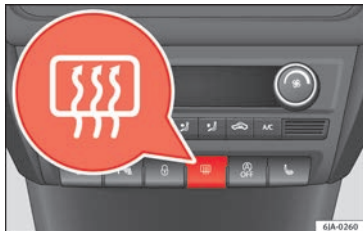
Abb. 137 Schalter für Heckscheibenheizung
