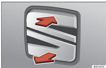
Abb. 126 Heckklappe: Öffnen von außen
