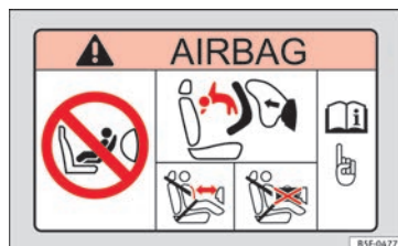
Abb. 22 Sonnenblende auf der Beifahrerseite: Airbagaufkleber.
