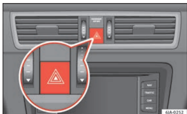
Abb. 29 Instrumententafel: Schalter für die Warnblinkanlage
