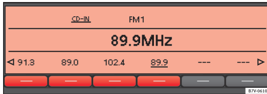
Abb. 5 Senderwechsel über die Wipptaste und Einstellung „SK MODE: PRESET“ (nur zu gespeicherten Sendern möglich).
