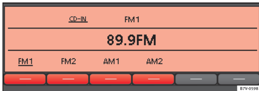
Abb. 7 Frequenzbereich und Speicherebene auswählen.
