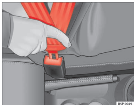
Abb. 12 Gurtschloss und Schloßzunge des Sicherheitsgurtes
