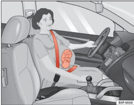
Abb. 15 Gurtbandverlauf bei schwangeren Frauen
