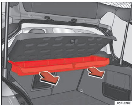
Abb. 124 Ausbau des Ablagefachs
