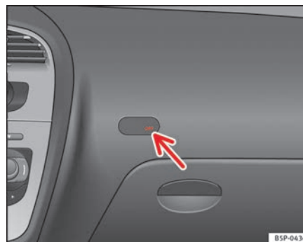
Abb. 27 Kontrollleuchte für Abschaltung der Beifahrerairbags
