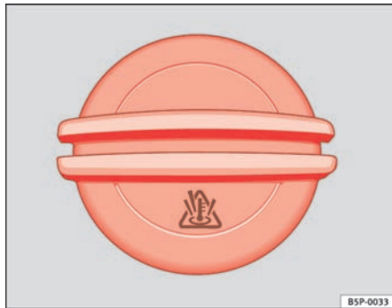
Abb. 158 Im Motorraum: Deckel des Kühlmittel- Ausgleichsbehälters
