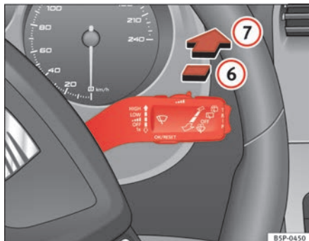
Abb. 87 Scheibenwischer- und Scheibenwaschhebel: Heckscheibenwischer
