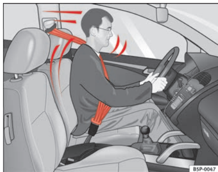
Abb. 11 Fahrer mit einem korrekt angelegten Sicherheitsgurt: er wird bei einer Vollbremsung durch den Gurt gesichert
