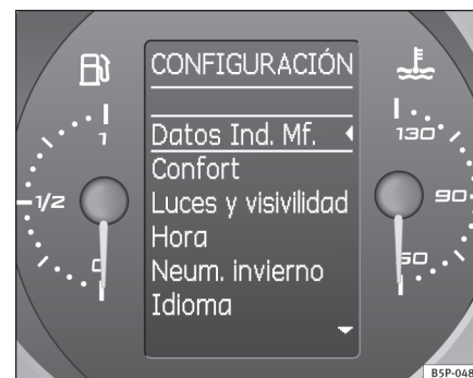
Abb. 47 Display des Kombiinstrumentes der Multifunktionsanzeige (MFA)
