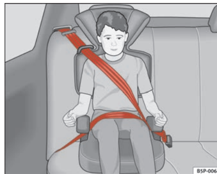
Abb. 30 In Fahrtrichtung eingebauter Kindersitz auf dem Rücksitz
