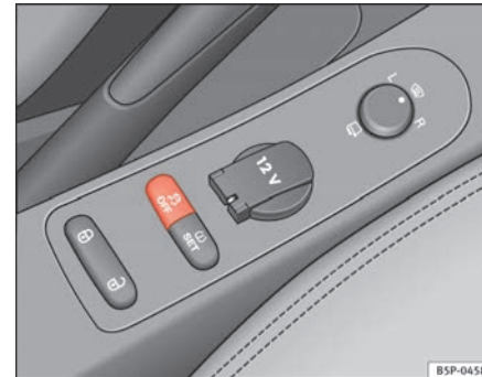
Abb. 135 In der Mittelkonsole: ESP-Taste
