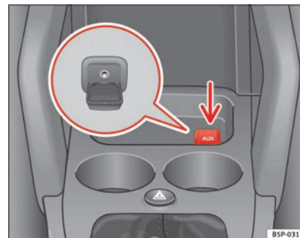
Abb. 118 Anschluss für einen zusätzlichen Audio-Eingang
