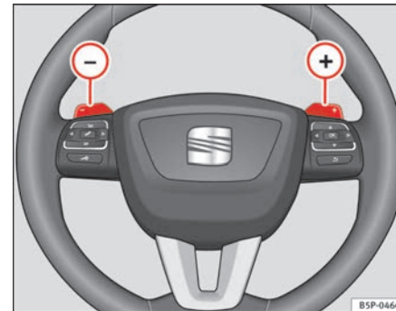
Abb. 144 Lenkrad mit Wippen für Automatikgetriebe
