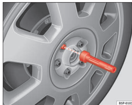
Abb. 172 Radwechsel: Innensechskant zum Drehen der Schrauben
