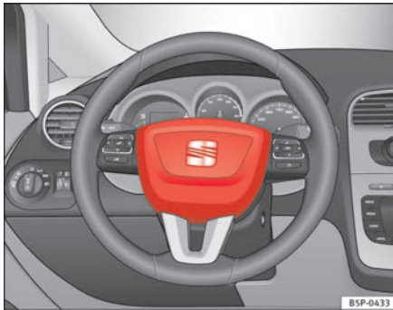
Abb. 18 Einbauort Fahrerairbag: im Lenkrad
