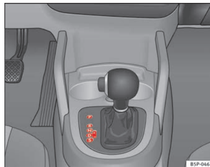
Abb. 139 Mittelkonsole: Wählhebel des Automatikgetriebes / Direktschaltgetriebes
