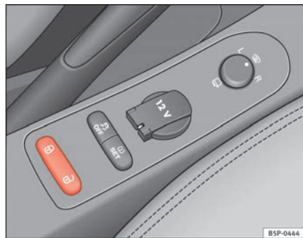
Abb. 58 In der Mittelkonsole: Zentralverriegelungstaster
