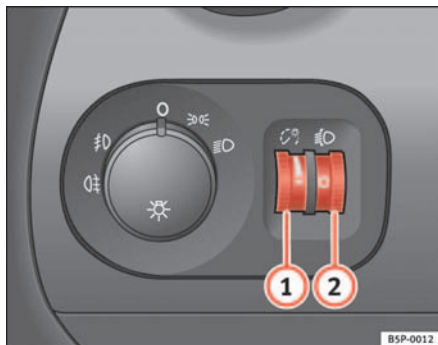
Abb. 76 Ausschnitt aus der Instrumententafel: Regler für die Instrumenten-/Schalterbeleuchtung und Leuchtweitenregulierung
