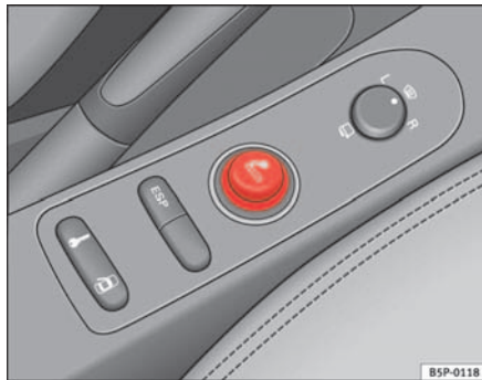
Abb. 114 Der Zigarettenanzünder befindet sich in der Steckdose der vorderen Mittelkonsole
