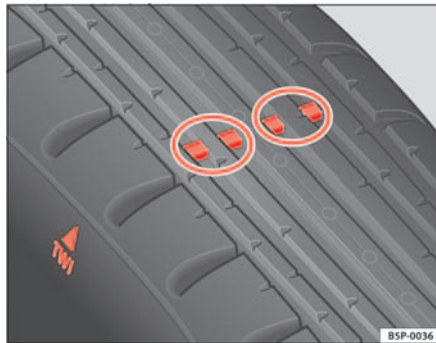
Abb. 162 Prinzipdarstellung Reifenprofil: Verschleißanzeiger
