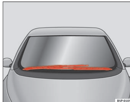
Abb. 158 Scheibenwischer in Service-Stellung
