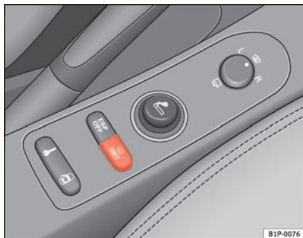
Abb. 48 Mittelkonsole: Taste des Reifendruckkontrollsystems
