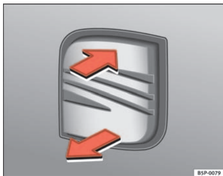
Abb. 67 Heckklappe: Öffnen von außen
