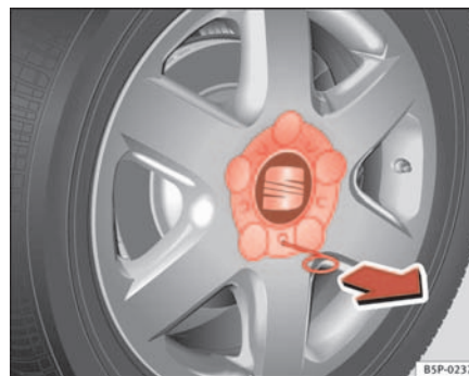
Abb. 165 Radwechsel: Radzierkappe abziehen
