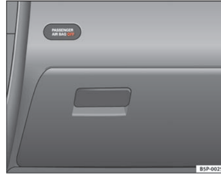
Abb. 27 Kontrollleuchte für Abschaltung der Beifahrerairbags
