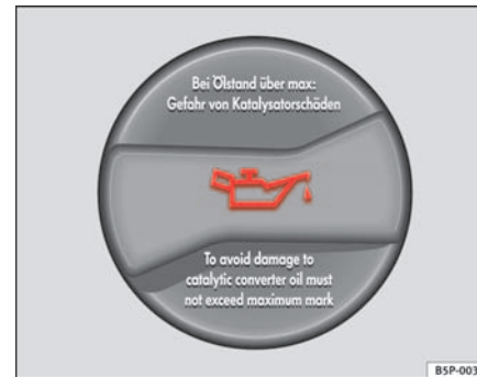
Abb. 155 Deckel der Motoröl-Einfüllöffnung im Motorraum
