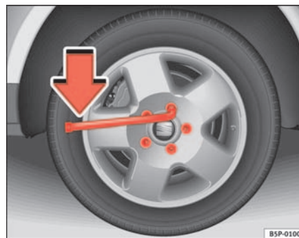
Abb. 166 Radwechsel: Radschrauben lockern
