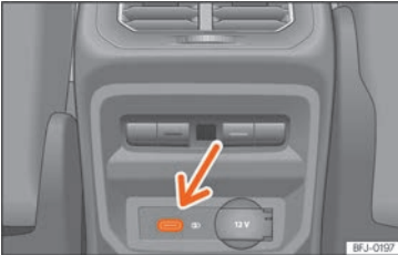
Abb. 185 Mittelkonsole hinten: USB-Anschlüsse mit Steckdosenfunktion.
