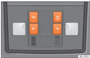
Abb. 106 Ausschnitt aus Dachhimmel: Innenbeleuchtung vorn.
