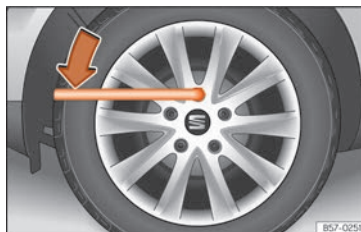
Abb. 252 Radwechsel: Radschrauben lockern
