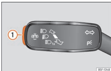
Abb. 129 Am Blinker- und Fernlichthebel: Taste für die Fahrerassistenzsysteme (modellabhängig).
