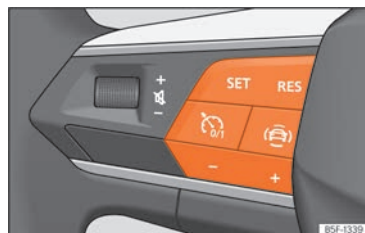
Abb. 138 Am Multifunktionslenkrad: Tasten zur Bedienung des Geschwindigkeitsbegrenzers.
