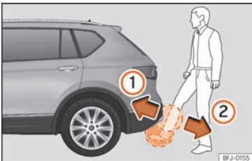
Abb. 78 Heckklappe mit sensorgesteuerter Öffnung (Easy Open).
