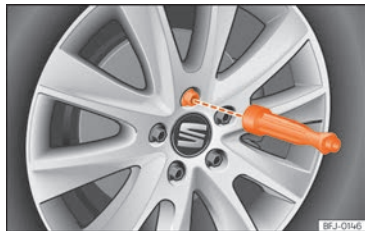
Abb. 256 Radwechsel: Radschrauben mit dem Schraubendrehergriff herausdrehen.
