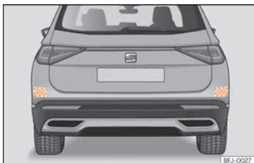
Abb. 134 Bereich hinter dem Fahrzeug: Bereiche der Radarsensoren.
