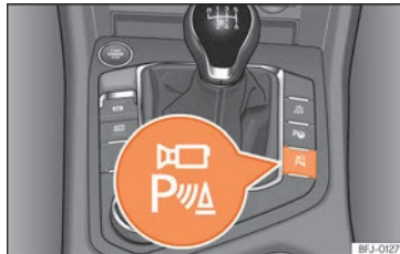
Abb. 170 Mittelkonsole: Taste zum manuellen Aktivieren und Deaktivieren der Rundumsicht in Verbindung mit dem Parkenassistent.
