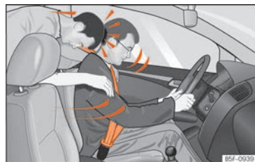
Abb. 24 Der nicht angegurte Mitfahrer auf dem Rücksitz wird nach vorn auf den angegurten Fahrer geschleudert.
