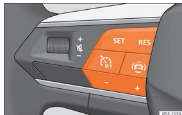
Abb. 137 Am Multifunktionslenkrad: Tasten zur Bedienung der Geschwindigkeitsregelanlage.
