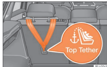
Abb. 46 Rückseite der Rücksitzbank der zweiten Reihe: Halteösen für den Top Tether Haltegurt.
