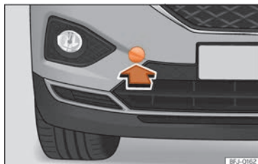
Abb. 224 Auf der rechten Seite des vorderen Stoßfängers: Abdeckung entfernen.
