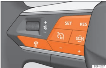
Abb. 140 Am Multifunktionslenkrad: Tasten zur ACC-Bedienung.
