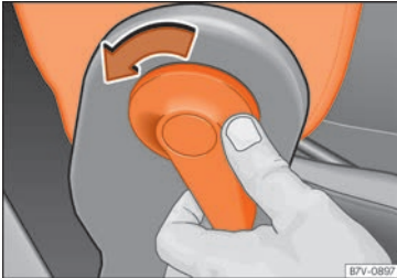
Abb. 90 Klappbare Beifahrersitzlehne entriegeln.
