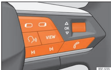
Abb. 15 Rechte Seite des Multifunktionslenkrads: Bedienelemente für die Menüs und Informationsanzeigen im Kombi-Instrument (modellabhängig).
