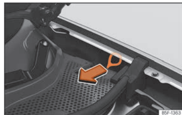
Abb. 58 Zwischen dem linken Kotflügel und dem Scharnier der Frontklappe: Ziehgriff für manuelle Notentriegelung des Ladesteckers.
