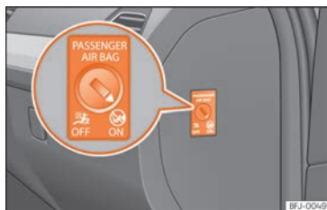
Abb. 32 Schlüsselschalter zum Ein- und Abschalten des Beifahrerairbags.
