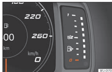
Abb. 60 Frei konfigurierbares Kombiinstrument: Kraftstoffvorratsanzeige
