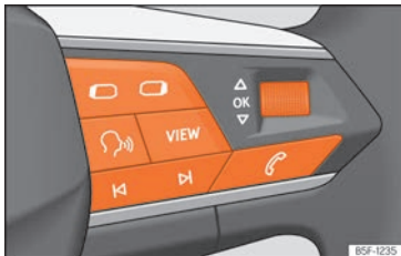
Abb. 62 Rechte Seite des Multifunktionslenkrads: Bedienelemente für die Menüs und Informationsanzeigen im Kombi-Instrument.
