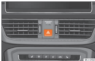
Abb. 95 Instrumententafel: Schalter für Warnblinkanlage.
