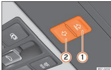
Abb. 90 Im Dachhimmel: Tasten des Sonnenschutzrollos.
