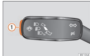
Abb. 63 Am Blinker- und Fernlichthebel: Taste für die Fahrerassistenzsysteme (modellabhängig).
