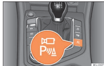
Abb. 215 Mittelkonsole: Taste zum manuellen Aktivieren und Deaktivieren der Rundumsicht in Verbindung mit dem Parklenkassistent.
