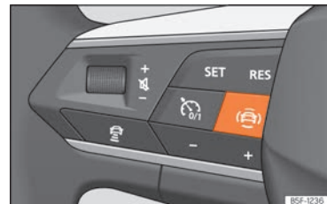
Abb. 64 Linke Seite des Multifunktionslenkrads: Taste für die Fahrerassistenzsysteme (modellabhängig).
