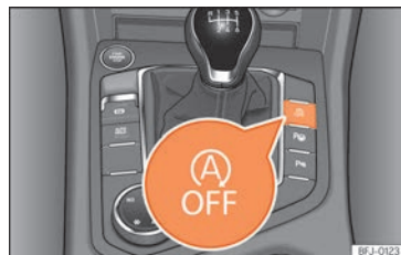
Abb. 163 Mittelkonsole: Taste des Start-Stopp-Systems.
