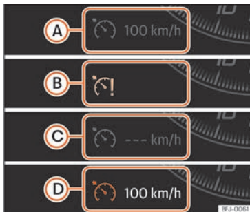
Abb. 178 Bildschirm des Kombi-Instruments: Zustandsanzeigen der GRA.
