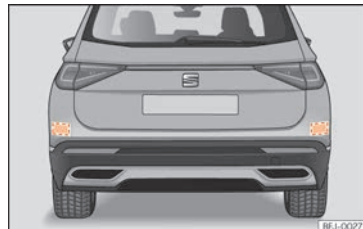
Abb. 175 Heckansicht des Fahrzeugs: Bereiche der Radarsensoren.
