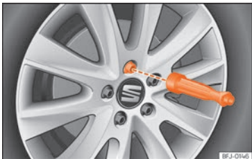
Abb. 39 Radwechsel: Radschrauben mit dem Schraubendrehergriff herausdrehen.
