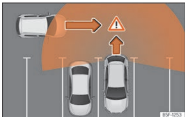
Abb. 198 Schematische Abbildung des Ausparkassistenten: Überwachter Bereich des ausparkenden Fahrzeugs.
