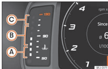
Abb. 61 Frei konfigurierbares Kombiinstrument: Motorkühlmittel-Temperaturanzeige.
