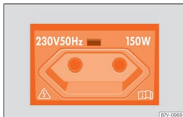
Abb. 145 Im Gepäckraum links: 230-Volt-Steckdose.
