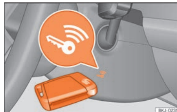
Abb. 162 Rechts an der Lenksäule: Notstart.
