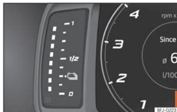
Abb. 59 Kombi-Instrument: Anzeige des Batterieladestatus.
