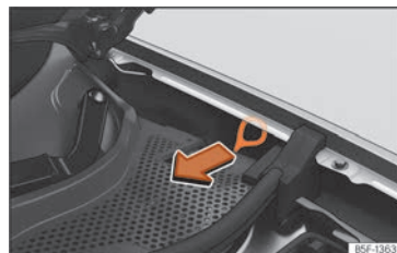
Abb. 230 Zwischen dem linken Kotflügel und dem Scharnier der Frontklappe: Ziehgriff für manuelle Notentriegelung des Ladesteckers.
