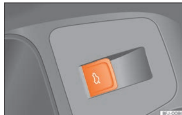
Abb. 85 An der Fahrertür: Taste zum Öffnen und Schließen der Heckklappe.
