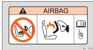
Abb. 24 Airbagaufkleber: an der Sonnenblende auf der Beifahrerseite
