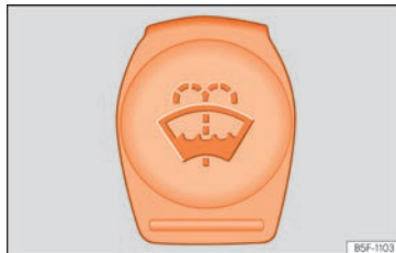
Abb. 247 Im Motorraum: Deckel des Scheibenwaschbehälters.
