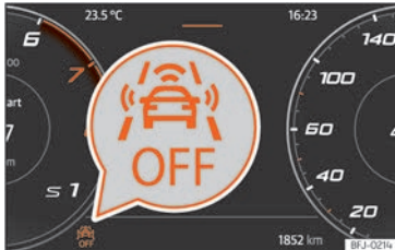
Abb. 183 Am Bildschirm des Kombi-Instruments: Anzeige, dass Front Assist ausgeschaltet ist.
