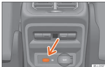
Abb. 160 Mittelkonsole hinten: USB-Anschlüsse mit Steckdosenfunktion.
