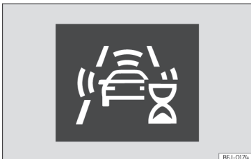
Abb. 184 Am Bildschirm des Kombi-Instruments: Anzeige der ersten Selbstkalibrierung des Systems.
