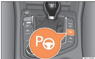
Abb. 201 Im oberen Teil der Mittelkonsole: Taste zum Einschalten des Parklenkassistenten.
