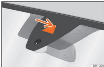
Abb. 174 An der Windschutzscheibe: Kamera-sichtfenster des Spurhalteassistenten.
