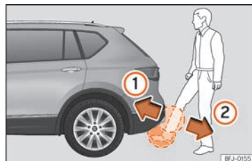
Abb. 86 Heckklappe mit sensorgesteuerter Öffnung (Easy Open).
