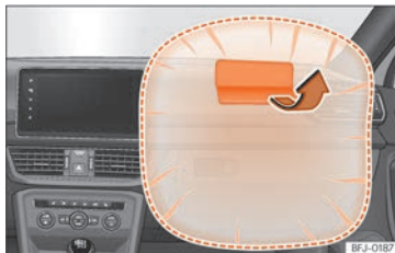
Abb. 16 Beifahrerairbag in der Instrumententafel
