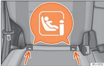
Abb. 26 Äußere Sitzplätze der zweiten Sitzreihe: ISOFIX/i-Size-Halteösen.
