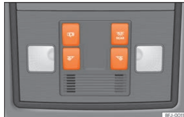
Abb. 100 Ausschnitt aus Dachhimmel:: Innenraumbeleuchtung vorn.
