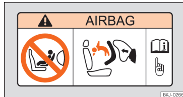
Abb. 26 Airbagaufkleber: an der Sonnenblende auf der Beifahrerseite
