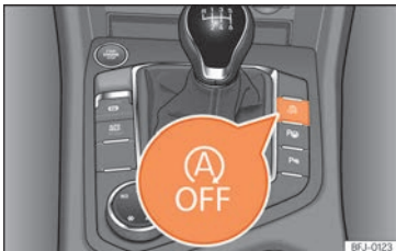
Abb. 243 Mittelkonsole: Taste des Start-Stopp-Systems.
