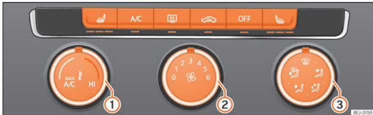
Abb. 154 In der Mittelkonsole: Bedienungselemente für die Klimaanlage.
