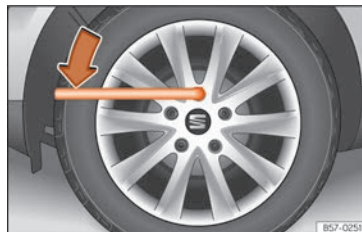
Abb. 38 Radwechsel: Radschrauben lockern.
