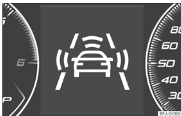
Abb. 257 Am Bildschirm des Kombi-Instruments: Anzeigen der Vorwarnung.
