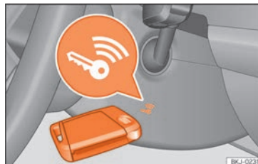
Abb. 241 Rechts an der Lenksäule: Notstart.
