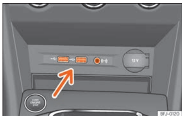
Abb. 236 Mittelkonsole: USB/AUX-IN Anschluss.
