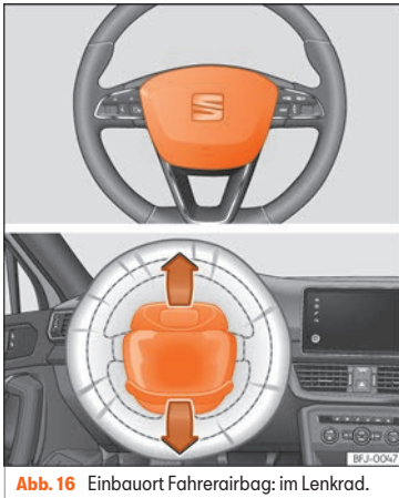
Abb. 16 Einbauort Fahrerairbag: im Lenkrad.
