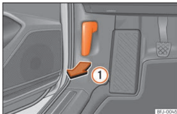
Abb. 310 Entriegelungshebel im Fahrerfußraum.
