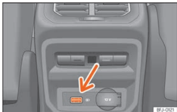
Abb. 237 Mittelkonsole hinten: USB-Anschlüsse.
