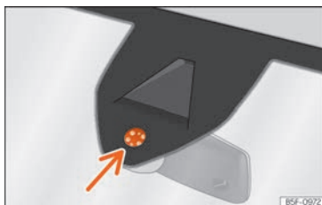
Abb. 103 Sensitive Fläche des Regensensors.
