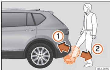
Abb. 87 Heckklappe mit sensorgesteuerter Öffnung (Easy Open).
