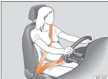
Abb. 13 Gurtbandverlauf bei schwangeren Frauen.
