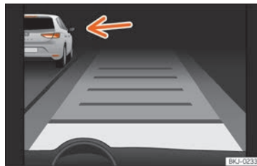
Abb. 267 Am Bildschirm des Kombi-Instruments: ACC aktiv, Fahrzeug auf der linken Seite erkannt
