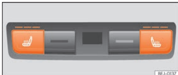
Abb. 158 In der Mittelkonsole hinten: Bedienelemente für die Sitzheizung der Rücksitze.
