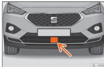
Abb. 264 Am vorderen Stoßfänger: Radarsensor.
