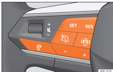
Abb. 6 Am Multifunktionslenkrad: Tasten zur ACC-Bedienung
