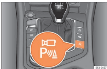
Abb. 296 Mittelkonsole: Taste zum manuellen Aktivieren und Deaktivieren der Rundumsicht in Verbindung mit dem Parklenkassistent.
