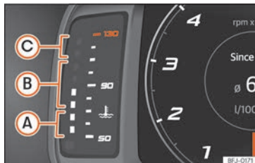
Abb. 63 Frei konfigurierbares Kombiinstrument: Motorkühlmittel-Temperaturanzeige.
