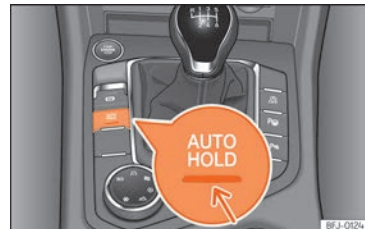
Abb. 280 Im unteren Teil der Mittelkonsole: Taste für die Auto Hold-Funktion.
