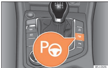
Abb. 281 Im oberen Teil der Mittelkonsole: Taste zum Einschalten des Parklenkassistenten.
