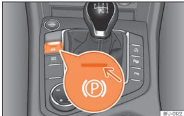
Abb. 278 Im unteren Teil der Mittelkonsole: Taste für elektronische Parkbremse.
