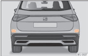
Abb. 274 Heckansicht des Fahrzeugs: Bereich der Radarsensoren.
