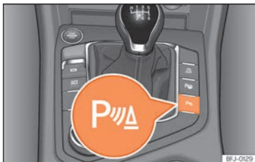
Abb. 288 Mittelkonsole: Taste für Einparkhilfe.
