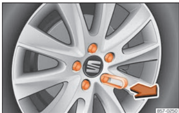
Abb. 36 Rad: Radschrauben mit Deckel.
