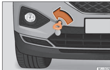
Abb. 49 Auf der rechten Seite des vorderen Stoßfängers: eingeschraubte Abschleppöse.
