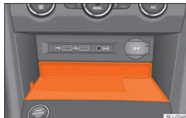
Abb. 239 In der Mittelkonsole: Aufnahme für die Mobiltelefonkopplung.
