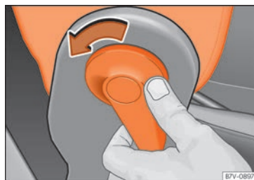
Abb. 118 Klappbare Beifahrersitzlehne entriegeln.
