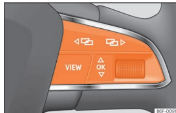
Abb. 64 Rechte Seite des Multifunktionslenkrads: Bedienelemente für die Menüs und Informationsanzeigen im Kombi-Instrument.
