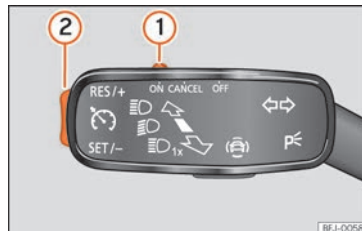
Abb. 252 Am Blinkerhebel: Bedienelemente zur Bedienung der GRA.
