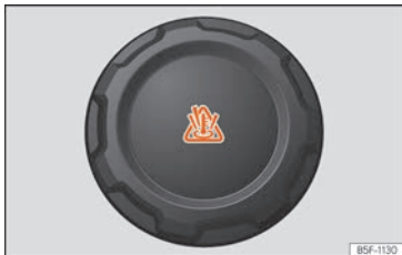
Abb. 316 Motorraum: Deckel des Motorkühlmittelausgleichsbehälters.
