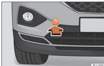
Abb. 48 Auf der rechten Seite des vorderen Stoßfängers: Abdeckung entfernen.
