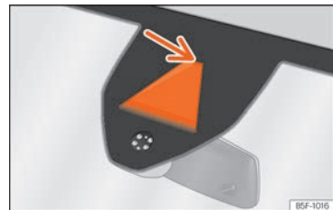
Abb. 270 An der Windschutzscheibe: Kamerasichtfenster des Spurhalteassistenten.
