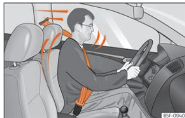
Abb. 7 Richtig angegurter Fahrer werden bei einem plötzlichen Bremsmanöver nicht nach vorne geschleudert.
