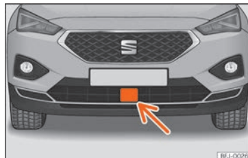
Abb. 258 Am vorderen Stoßfänger: Radarsensor.
