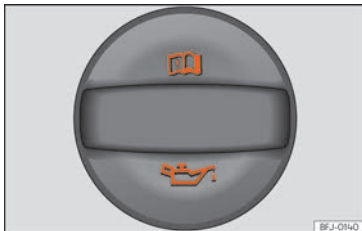
Abb. 314 Deckel der Motoröl-Einfüllöffnung im Motorraum
