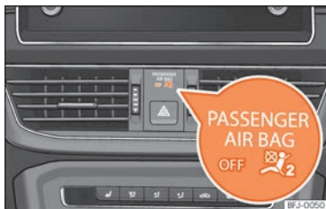
Abb. 19 Instrumententafel: Kontrollleuchte für Abschaltung des Beifahrerairbags.
