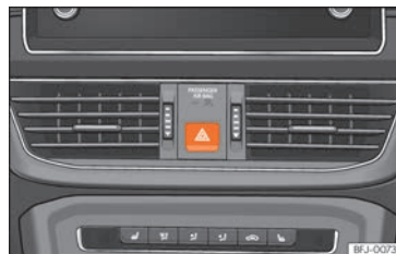
Abb. 98 Instrumententafel: Schalter für Warnblinkanlage.
