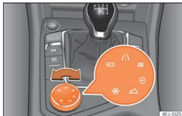
Abb. 249 Mittelkonsole: Drehknopf (Driving Experience button).
