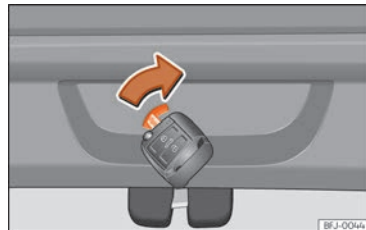
Abb. 11 Ausschnitt Gepäckraum: Notfallentriegelung.
