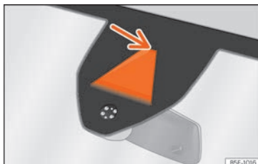
Abb. 270 Kamerasichtfenster des Spurhalteassistenten.
