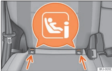
Abb. 37 Äußere Sitze der zweiten Sitzreihe: Befestigungsösen ISOFIX/i-Size.
