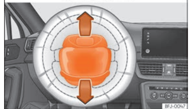
Abb. 26 Einbauort Fahrerairbag: im Lenkrad.
