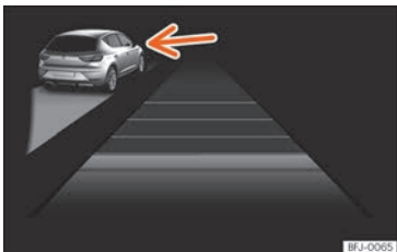
Abb. 267 Im Display des Kombiinstrumentes: ACC aktiv, Fahrzeug auf der linken Seite erkannt
