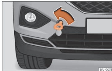
Abb. 79 Vorderer Stoßfänger rechts: Eingeschraubte Abschleppöse
