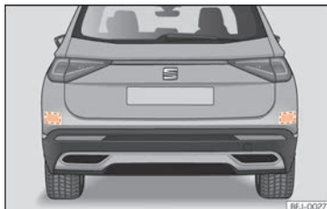
Abb. 274 Bereich hinter dem Fahrzeug: Bereiche der Radarsensoren.
