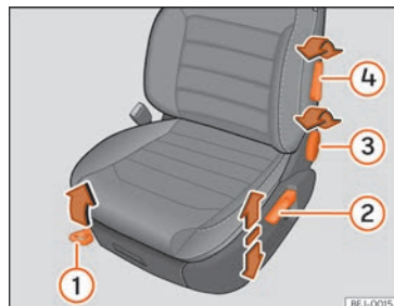
Abb. 18 Vordersitze: Manuelle Sitzverstellung.
