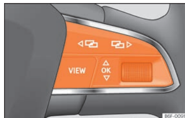
Abb. 114 Rechte Seite des Multifunktionslenkrads: Bedienelemente für die Menüs und Informationsanzeigen im Kombiinstrument.
