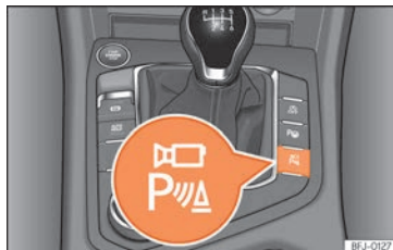
Abb. 292 Mittelkonsole: Taste zum manuellen Ein-/Ausschalten der Rundumsicht in Verbindung mit der Einparkhilfe (A) oder mit dem hinteren ParkPilot (B).
