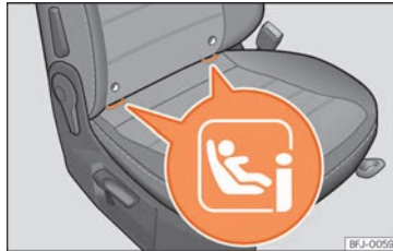
Abb. 38 Beifahrersitz: Befestigungsösen ISOFIX.
