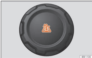
Abb. 62 Motorraum: Deckel des Motorkühlmittelauflagebehälters
