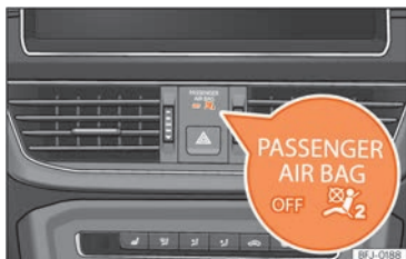
Abb. 18 Instrumententafel: Kontrollleuchte für Abschaltung des Beifahrerairbags.
