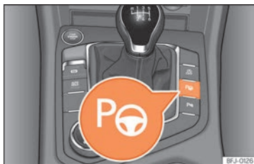
Abb. 200 Im oberen Teil der Mittelkonsole: Taste zum Einschalten des Parklenkassistenten.
