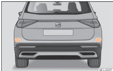
Abb. 176 Heckansicht des Fahrzeugs: Bereiche der Radarsensoren.
