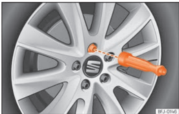
Abb. 39 Radwechsel: Radschrauben mit dem Schraubendrehergriff herausdrehen.
