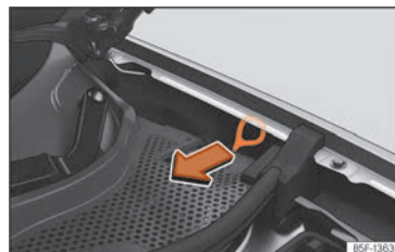
Abb. 229 Zwischen dem linken Kotflügel und dem Scharnier der Frontklappe: Ziehgriff für manuelle Notentriegelung des Ladesteckers.
