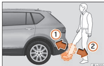
Abb. 87 Heckklappe mit sensorgesteuerter Öffnung (Easy Open).
