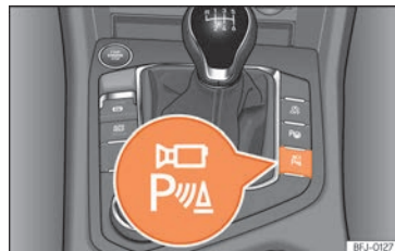
Abb. 214 Mittelkonsole: Taste zum manuellen Aktivieren und Deaktivieren der Rundumsicht in Verbindung mit dem Parklenkassistent.
