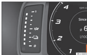
Abb. 60 Kombi-Instrument: Anzeige des Batterieladestands.
