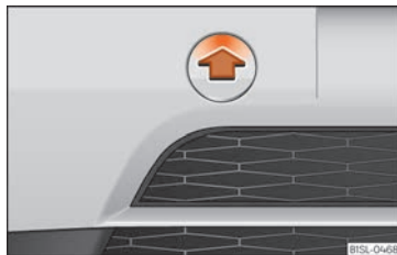
Abb. 42 Stoßfänger vorn rechts: Abdeckung entfernen.
