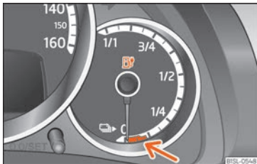
Abb. 148 Im Kombiinstrument: Ladezustands- anzeige der Hochvoltbatterie mit rot gekenn- zeichnetem Reservebereich (Pfeil).
