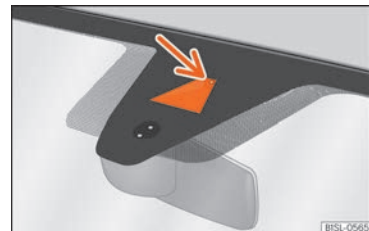
Abb. 140 An der Windschutzscheibe: Kamera-sichtfenster des Spurhalteassistenten.
