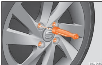
Abb. 37 Radwechsel: Radschrauben mit dem Schraubendrehergriff lockern.
