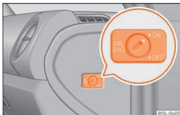
Abb. 15 Schlüsselschalter zum Ein- und Abschalten des Beifahrerairbags.
