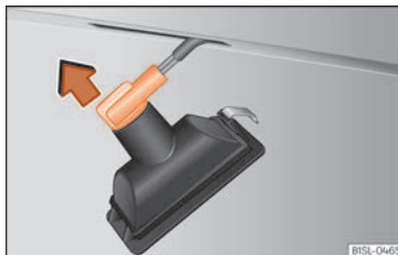
Abb. 55 Kennzeichenleuchte: Lampenhalter ausbauen.
