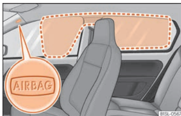
Abb. 19 Einbauort und Entfaltungsbereich des Kopfairbags.
