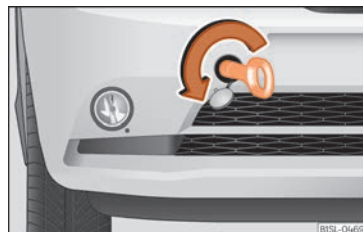
Abb. 43 Stoßfänger vorn rechts: eingeschraubte Abschleppöse.
