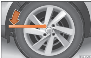
Abb. 33 Radwechsel: Radschrauben lockern.
