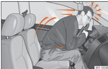
Abb. 7 Der nicht angegurtete Fahrer schleudert nach vorn.
