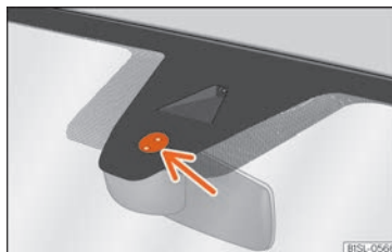
Abb. 86 Sensitive Fläche des Regensensors.
