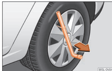
Abb. 30 Die Radvollblende vom Rad abnehmen.
