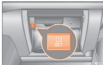
Abb. 169 im Handschuhfach: Taste für die Reifendruckkontrollanzeige.
