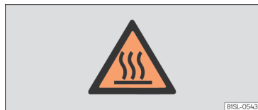
Abb. 146 Am Ladegerät, im Motorraum: Warnung vor heißer Oberfläche.
