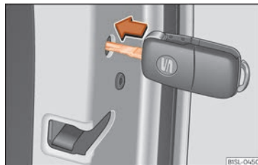
Abb. 71 Notverriegelung des Fahrzeugs mit dem Fahrzeugschlüssel.
