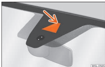
Abb. 140 An der Windschutzscheibe: Kamerasichtfenster des Spurhalteassistenten.
