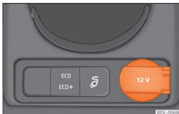
Abb. 105 Mittelkonsole vorn: 12-Volt-Steckdose im Ablagefach und USB-Schnittstelle.
