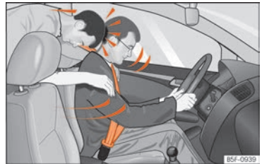
Abb. 8 Der nicht angegurtete Mitfahrer auf dem Rücksitz schleudert nach vorn auf den angegurteten Fahrer.
