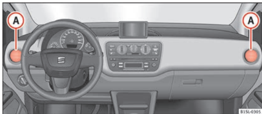
Abb. 78 In der Instrumententafel: Luftaustrittsdüsen.
