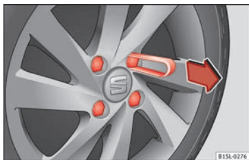
Abb. 126 Abdeckkappen von den Radschrauben abziehen.
