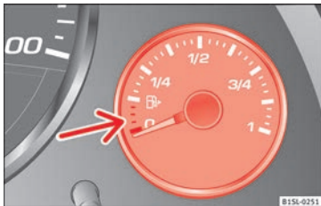
Abb. 101 Im Kombiinstrument: Kraftstoffvorratsanzeige für Benzin.
