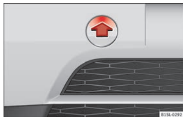
Abb. 135 Im Stoßfänger vorn rechts: Abdeckung abnehmen.
