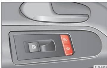
Abb. 34 An der Fahrertür: Zentralverriegelungstaster.
