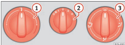
Abb. 76 Auf der Mittelkonsole: Drehregler des Heiz- und Frischluftsystems.
