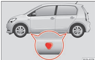
Abb. 129 Aufnahmepunkte für den Wagenheber.
