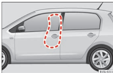
Abb. 15 Auf der linken Fahrzeugseite: Entfaltungsbereich des Seitenairbags.
