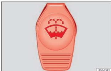
Abb. 112 Im Motorraum: Deckel des Scheibenwaschbehälters.
