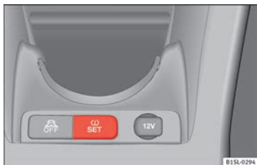
Abb. 117 Mittelkonsole: Taste für die Reifenkontrollanzeige
