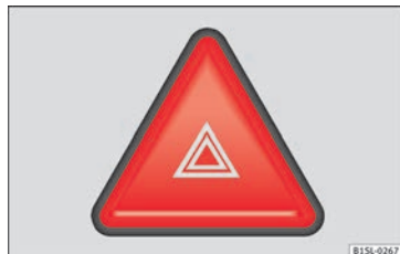
Abb. 121 Instrumententafel: Taste zum Ein- und Ausschalten der Warnblinkanlage.
