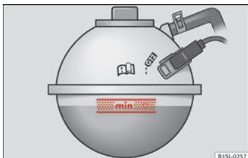
Abb. 109 Im Motorraum: Markierung an dem Motorkühlmittelausgleichbehälter.
