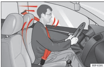
Abb. 7 Richtig angegurtete Fahrer werden bei einem plötzlichen Bremsmanöver nicht nach vorne geschleudert.
