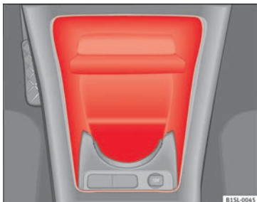
Abb. 98 In der Mittelkonsole vorn: Ablagefach mit Getränkehalter.
