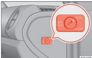
Abb. 17 Auf der Beifahrerseite: Schlüsselschalter zum Ab- und Einschalten des Beifahrer-Frontairbags.
