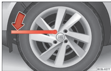
Abb. 127 Radwechsel: Radschrauben lockern.
