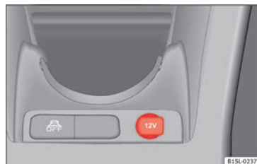
Abb. 68 Mittelkonsole vorn: 12-Volt-Steckdose im Ablagefach.
