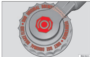
Abb. 111 Im Motorraum: Deckel des Bremsflüssigkeitsbehälters
