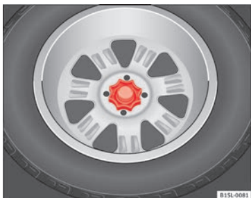
Abb. 118 Im Gepäckraum: Handrad zur Befestigung des Reserverads.
