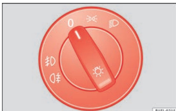
Abb. 43 Neben dem Lenkrad: Darstellung einiger Varianten des Lichtschalters.
