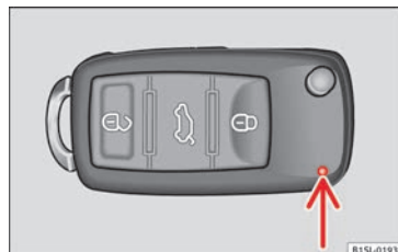
Abb. 29 Kontrollleuchte im Fahrzeugschlüssel.
