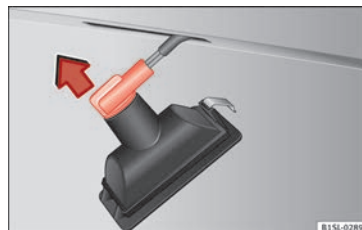
Abb. 152 Kennzeichenleuchte: Lampenträger ausbauen. »
