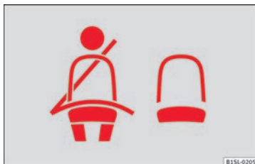
Abb. 6 Gurtstatusanzeige für die hinteren Sitzplätze im Display des Kombiinstrumentes.
