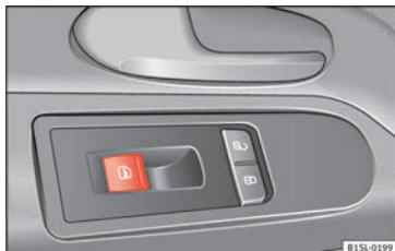
Abb. 39 An der Fahrertür: Taste für den Fensterheber.
