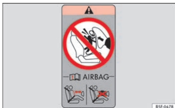
Abb. 19 Im hinteren Rahmen der Beifahrertür: Aufkleber mit Angaben zum Airbag.
