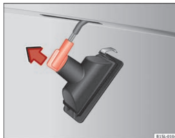
Abb. 159 Kennzeichenleuchte: Lampenhalter ausbauen.
