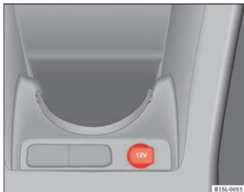
Abb. 85 Mittelkonsole vorn: 12-Volt-Steckdose im Ablagefach.
