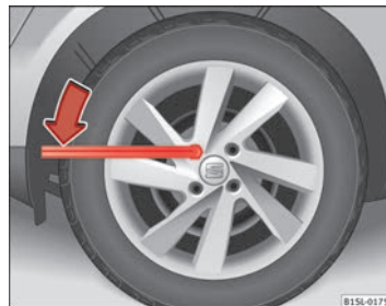
Abb. 144 Radwechsel: Radschrauben lockern.
