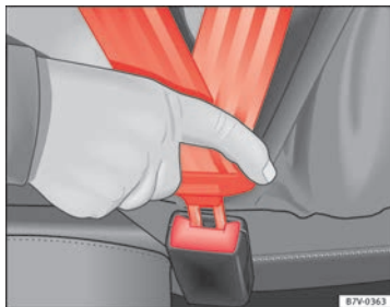
Abb. 42 Schließung des Sicherheitsgurts in das Gurtschloss einstecken.
