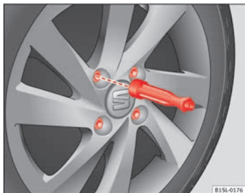
Abb. 148 Radwechsel: Radschrauben mit dem Schraubendrehergriff ab- schrauben.
