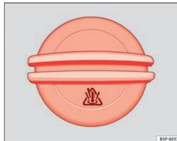
Abb. 117 Im Motorraum: Deckel des Motorkühlmittelausgleichsbehälters.
