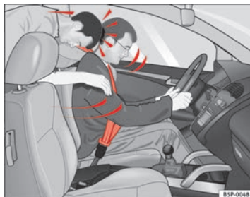
Abb. 40 Der nicht angegurte Mitfahrer auf dem Rücksitz schleudert nach vorn auf den angegurten Fahrer.
