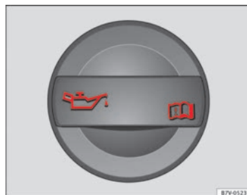
Abb. 115 Im Motorraum: Deckel der Motoröleinfüllöffnung. ▶
