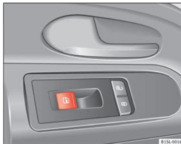
Abb. 24 An der Fahrertür: Taste für den Fensterheber.
