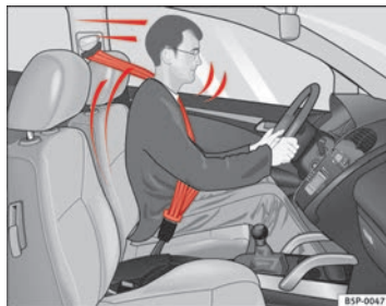
Abb. 41 Angegurter Fahrer, der bei einem plötzlichen Bremsmanöver vom richtig angelegten Sicherheitsgurt aufgefangen wird.
