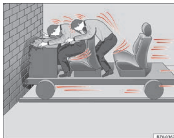
Abb. 38 Ein Fahrzeug fährt mit nicht angelegten Insassen an die Mauer.
