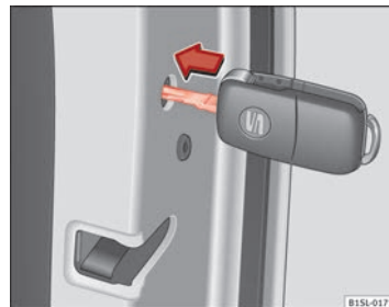
Abb. 137 Notverriegelung des Fahrzeugs mit dem Fahrzeugschlüssel.
