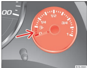
Abb. 108 Im Kombiinstrument: Kraftstoffvorratsanzeige für Benzin.
