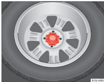
Abb. 126 Im Gepäckraum: Handrad zur Befestigung des Reserverads. ▶
