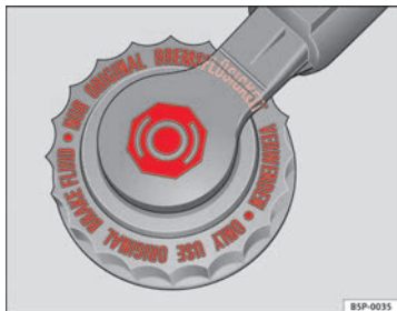
Abb. 94 Im Motorraum: Deckel des Bremsflüssigkeitsbehälters
