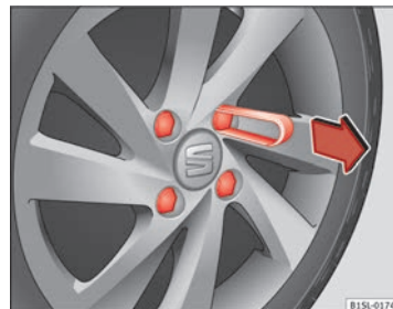
Abb. 143 Abdeckkappen von den Radschrauben abziehen.
