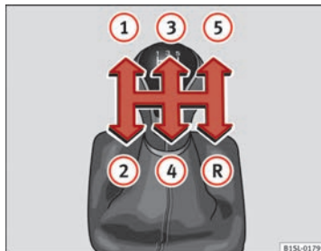
Abb. 89 Schaltschema des 5-Gang-Schaltgetriebes.
