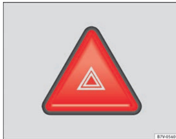
Abb. 133 In der Instrumententafel: Taste zum Ein- und Ausschalten der Warnblinkanlage.
