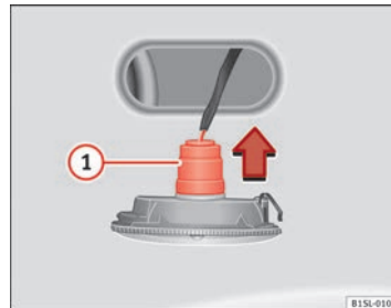
Abb. 161 Seitliche Blinkleuchte: Glühlampe austauschen.
