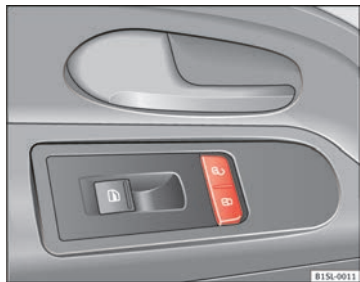
Abb. 19 An der Fahrertür: Zentralverriegelungstaster.
