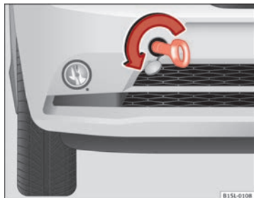
Abb. 165 Im Stoßfänger vorn rechts: Abschleppöse einschrauben.
