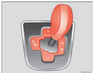
Abb. 90 Wählhebel für das Automatikgetriebe.
