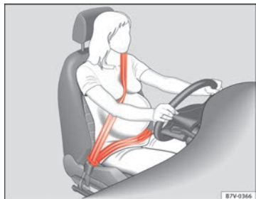
Abb. 45 Richtiges Gurtbandverlauf bei schwangeren Frauen.
